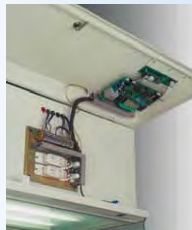
Acceso directo al sistema de control desde el frontal de la cabina
