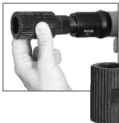
La vissuse est munie d'un réglage externe du couple de serrage.
