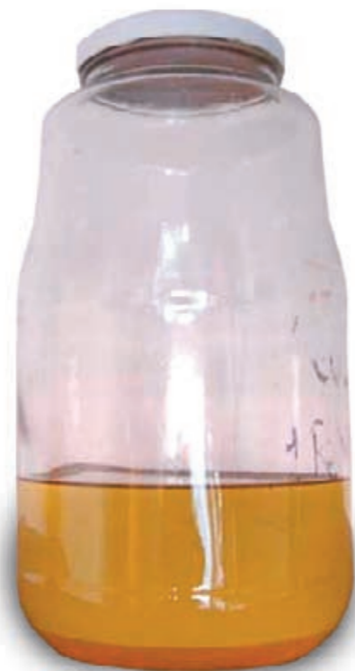
Na slici vidimo kako se nakon što je smjesa odstajala 8 sati glicerol (tamniji sloj) nataložio na dnu posude. Svjetliji dio tekućine su čisti metilni esteri to jest biodizel.
