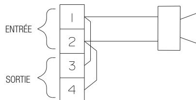
Pour les versions 8Ω, il existe un bloc de jonction à 4 voies pour un raccordement direct aux fils pilotes, comme indiqué ci-dessus
