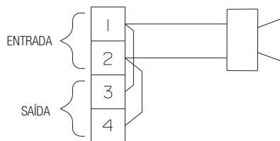
Para as versões 8, há um bloco de terminal único de 4 vias para a ligação directa aos cabos condutores, conforme ilustrado acima.
