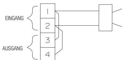
Die 8fi-Versionen enthalten eine einzelne 4-fach-Reihenklemme zum direkten Anschluss der Lautsprecherdrähte, siehe Abbildung.
