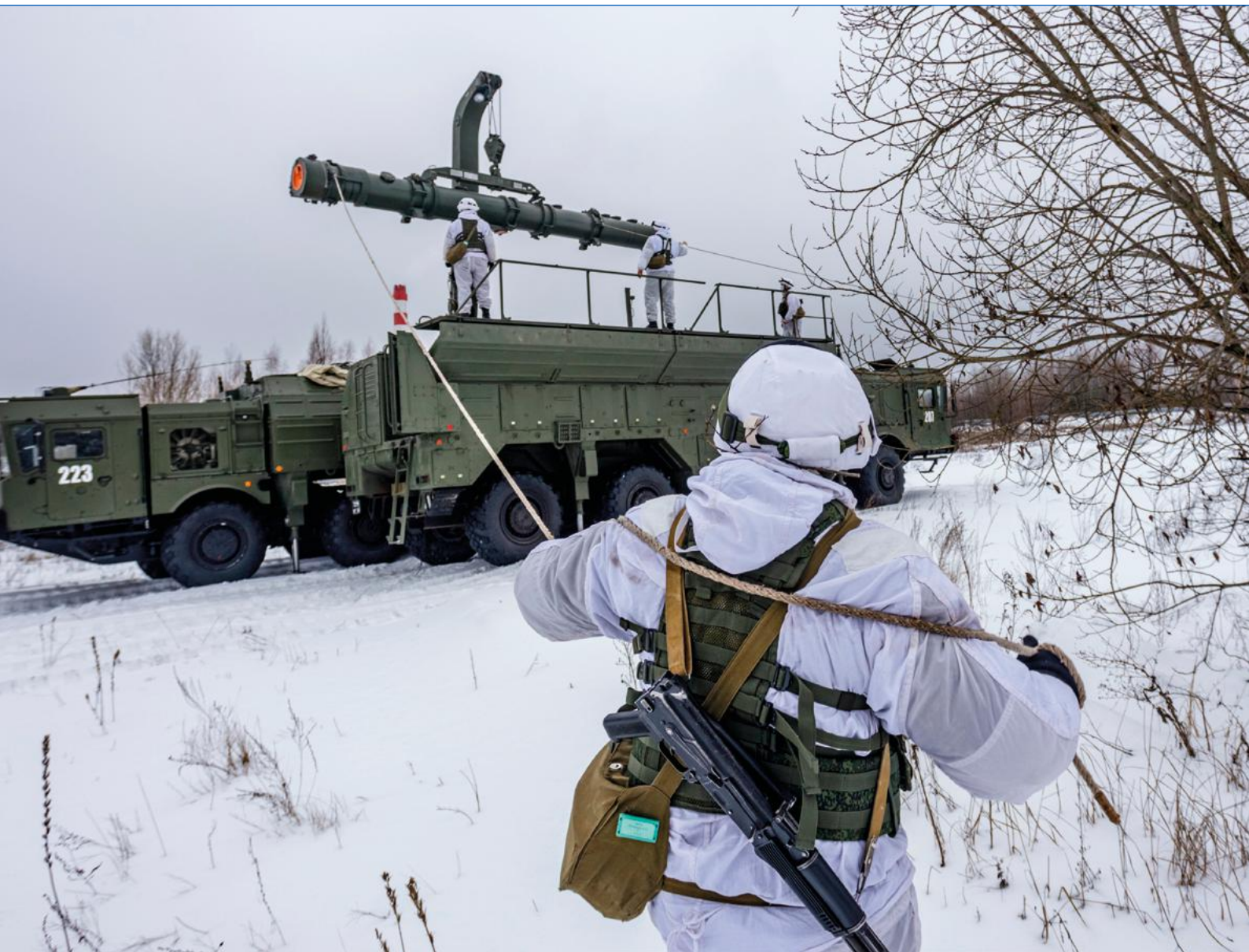
In het analytische hoofdstuk 3 komen tal van dreigingen langs, maar is onder andere een hoofdrol weggelegd voor Rusland. Op deze foto uit februari 2021 staan Russische troepen tijdens een oefening met een 9K720 Iskander; een ballistisch raketsysteem voor de korte afstand (foto: Vectorkel / Shutterstock.com)
