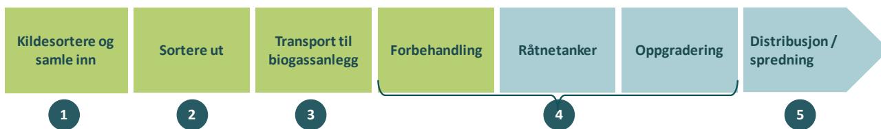
Figur 3-5: Verdikjeden til produksjon av biogass og biogjødsel (basert på matavfall)
