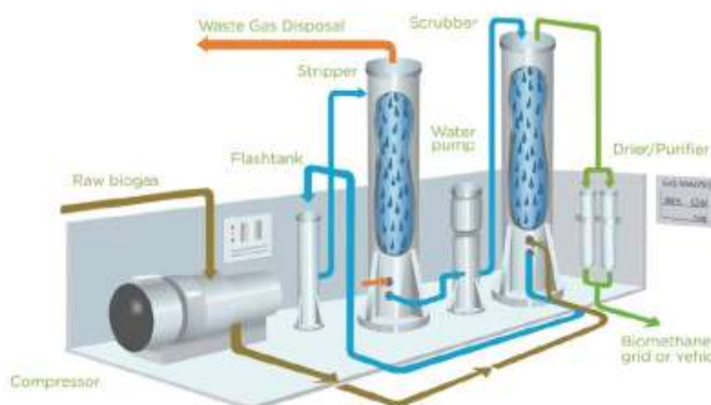
Figur 6. Skjemaskisse Greenlanes vannskrubberteknologi (over), på et ferdig installert anlegg (til høyre).
