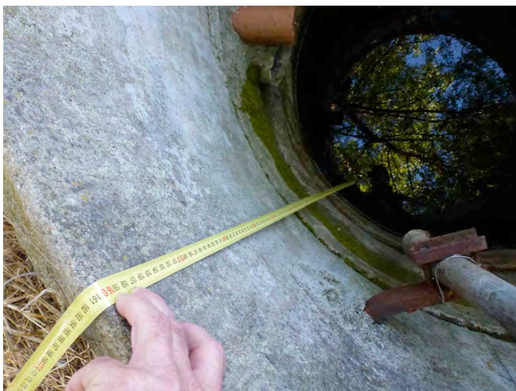
Photo 5. Mesure du niveau de la nappe dans le puits « B » de Caylus le 25 août 2015
