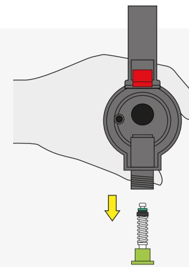
**NL** - Houdt de pomp vast in deze positie en zorg ervoor dat de borgring zover mogelijk in de behuizing wordt gedrukt.
