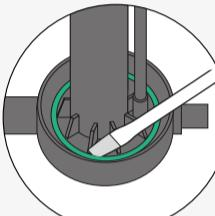
Vervang O-ring **D** (56,74 x 3,53 mm). (Let op! Bij het plaatsen van de nieuwe O-ring druk deze zachtjes aan op zijn plek. Zorg ervoor dat de O-ring gelijkmatig verdeeld op zijn plek zit.) Vervang pomppakking **F**.
