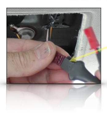
CONNECT THE BLACK CONNECTOR ON THE TDB023 TO THE HARNESS CONNECTOR ON THE VEHICLE
