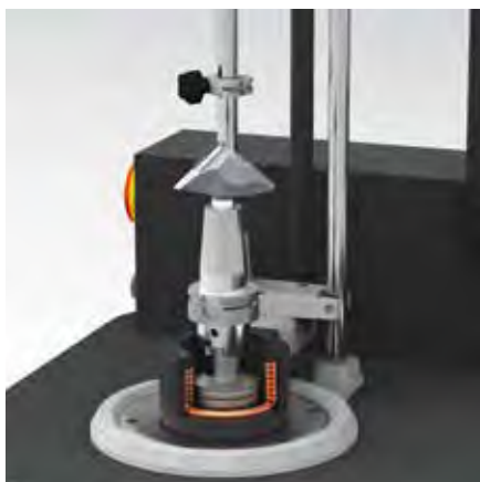
Bild1: Einsetzen Werkzeugträger Image1: Inserting tool adaptors
