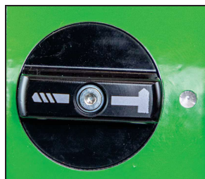
Hammersymbol på mærket - boring med milde slag
