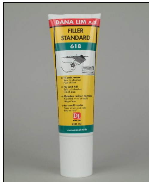
Filler Standard 618 er en færdigblandet acrylspartelmasse med cellulosefibre, der forbedrer vedhæftning og styrke, og giver minimalt svind.
