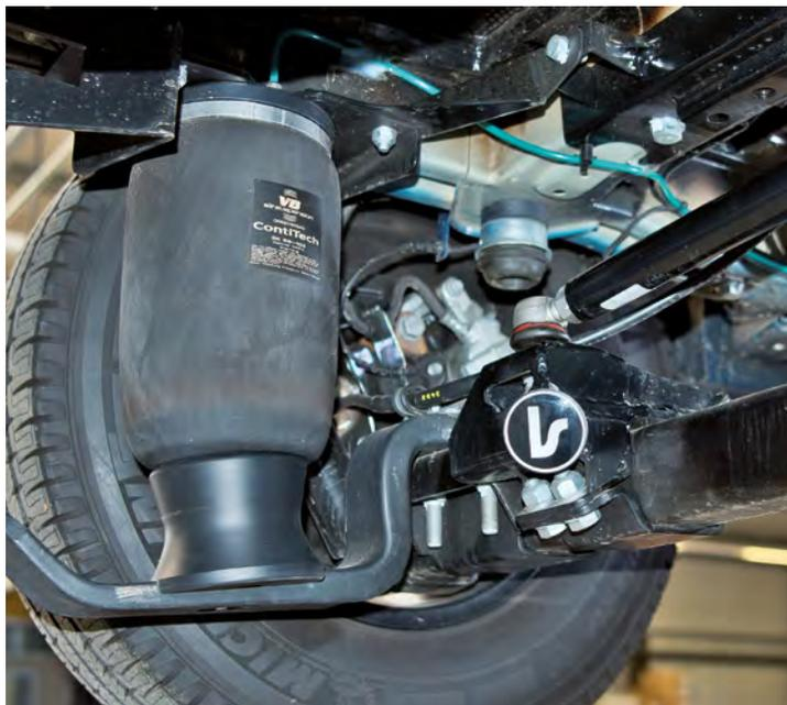
Vollluftfederung an der Hinterachse
