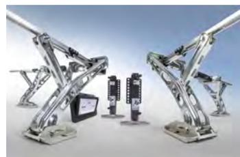
Jedes E&P-Levelsystem wird genau abgestimmt auf die Achse des Fahrzeugs, an der es montiert wird. Die Elektronik reguliert den Hub der Stützen über den Druck im jeweiligen Zylinder. Dadurch kommt das System komplett ohne anfällige elektrische Sensoren an den Stützen aus. Alle Levelsysteme werden ohne Schweißarbeiten mit speziell für den jeweiligen Fahrzeug- und Aufbautypen konstruierten Adaptern an tragenden Stellen des Chassis befestigt.
