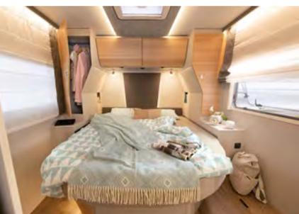
Das Queensbett in den DBM- und DBL-Grundrissen ist höhenverstellbar und schafft so bei Bedarf mehr Stauraum in der Heckgarage darunter
