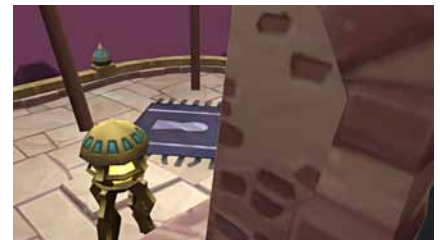
Abbildung 4 Im ersten Schritt wird die statische Level-Geometrie gerendert, die auch den Vordergrund bildet.
