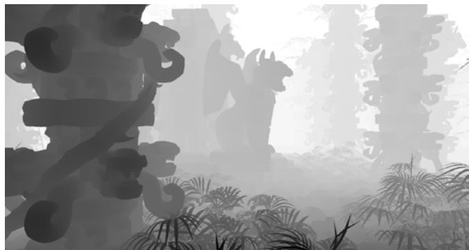
Abbildung 2 Darstellung der Z-Buffer-Werte einer 3D-Szene. Hellere Pixel sind weiter von der Kamera entfernt als dunkle Pixel. Die Szene stammt aus der »High Temple«-Demo von 3DMark 11.
