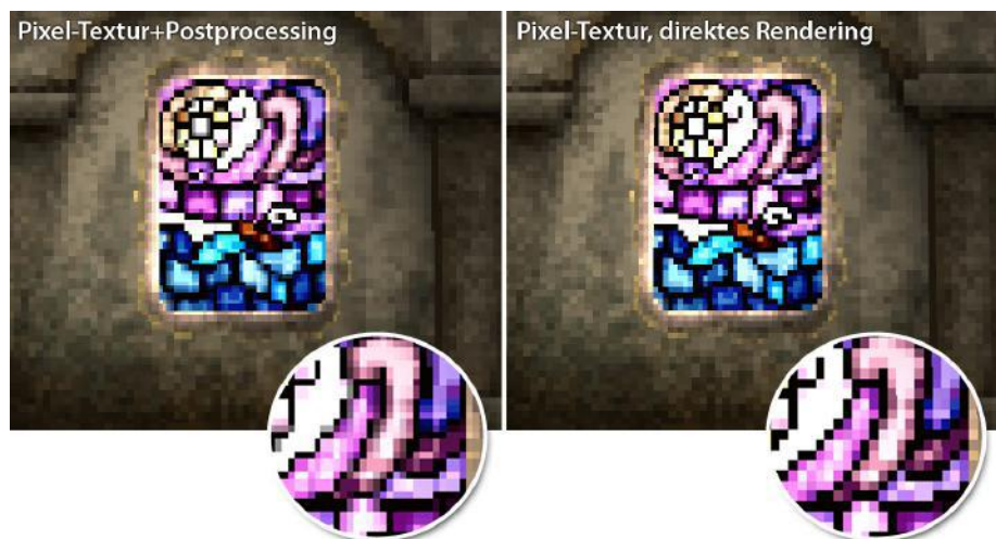
Abbildung 9: Befinden sich feine Details in der Textur, so kommt es beim Postprocessing zu Interferenzen (links). In einigen Fällen lässt sich dieses Problem durch Deaktivierung der Pixelierung und einer senkrechten Kameraperspektive lösen (rechts).
