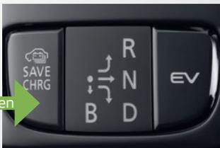
Durch erneutes Drücken der „SAVE/CHRG“-Taste wird der Charge-Modus aktiviert. Der Verbrennungsmotor treibt das Stromaggregat an und der Akku wird während der Fahrt geladen. In ca. 40 Minuten können maximal 80% der Batteriekapazität geladen werden.
