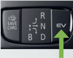
Sobald Sie durch Drücken die EV-Priority-Funktion aktiviert haben, fährt der Eclipse Cross Plug-in Hybrid so oft wie möglich im rein elektrischen Modus. Sie reduzieren damit aktiv CO<sub>2</sub>-Emission und Motorengeräusche.
