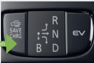
Durch Drücken der „SAVE/CHRG“-Taste wird der Save-Modus aktiviert, um die Akkuleistung für später aufzusparen. Der Save-Modus greift erst bei weniger als 90% Batterieladestand.
