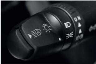
Durch Drehen am Hebel links vom Lenkrad lassen sich die Scheinwerfer bedienen. Der Fernlichtassistent lässt sich, wenn der Drehhebel in der Position „AUTO“ oder „ABBLENDLICHT“ steht, durch Drücken der Taste am Ende des Hebels aktivieren oder deaktivieren. Der Fernlichtassistent unterstützt den Fahrer bei Nachtfahrten und blendet je nach Verkehrssituation und Lichtverhältnissen automatisch auf oder ab.
