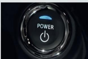
Fahrzeug zum Stillstand bringen, mittels Start-Stopp-Knopf ausschalten. Die Wählhebel-Position „P“ wird hierdurch automatisch aktiviert. Das Fahrzeug sollte zusätzlich mit der elektronischen Parkbremse gegen Wegrollen gesichert werden.
