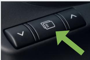
Dieser Schalter verändert bei jeder Betätigung die Anzeige im Multifunktionsdisplay des Fahrzeugs. Die Anzeige wechselt beispielsweise zwischen Informationen wie Tageskilometerzähler, elektrischer Reichweite, Reichweite gesamt und Energiefluss sowie Einstellungen, wie z. B. dem Totwinkelassistenten u. v. m.
