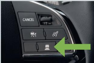
Über den „ACC“-Abstandsschalter<sup>1</sup> lässt sich bei aktiver Tempoautomatik die Distanz des Abstandshalters in vier Stufen (weit bis nah) einstellen. Durch
