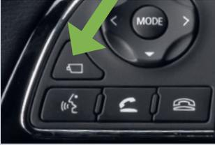
Die 360-Grad-Kamera<sup>1</sup> wird entweder durch Einlegen des Rückwärtsgangs oder durch Betätigen des Schalters am Lenkrad (z.B. auch beim vorwärts Einparken) aktiviert. Bei mehrmaligem Drücken verändert sich zudem der Sichtbereich der Umgebungskameras
