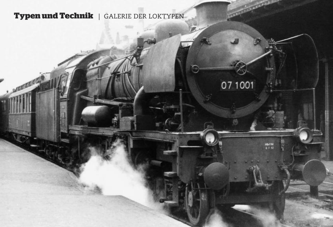
Nur selten wurde die in Frankreich gebaute, bei der DR modifizierte und mit Kohlenstaubfeuerung ausgerüstete 07 1001 im Zugbetrieb genutzt; hier ein Foto aus den frühen 50er-Jahren ZBDR/Histor. Slg. DB
