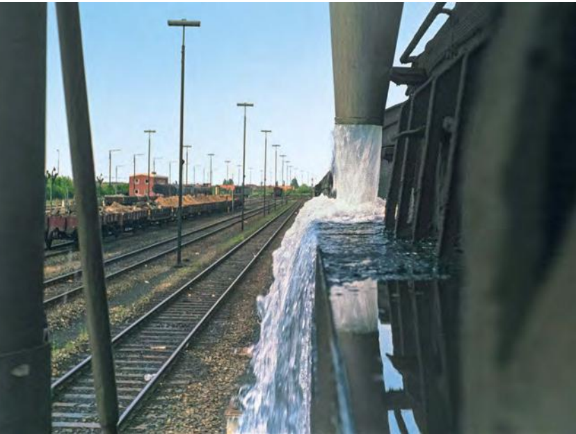
Wasser fassen in Emden. 38 Kubikmeter des kühlen Nass kann der große fünfsichtige Tender der 012 aufnehmen, aber im Eifer des Gefechts geht diesmal ein bisschen was daneben
