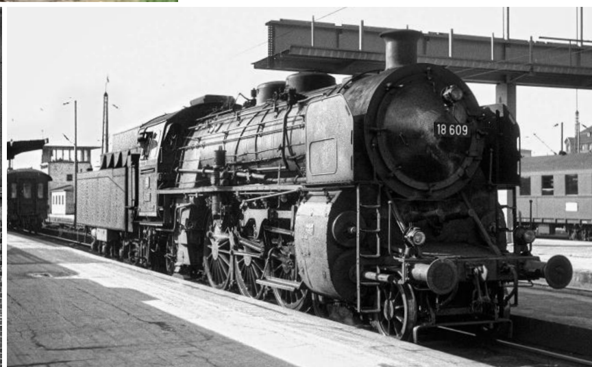
Bahnbetrieb in München: Am 13. März 1960 hat die neu bekesselte 18 609 (bay. S 3/6) ihren Lindauer Zug in die bayerische Landeshauptstadt gebracht und rollt nun Tender voran Richtung Bahnbetriebswerk Harald Schönfeld
