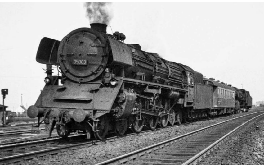
Theoretisch hätten die 2'C 2'-Maschinen der Baureihe 05 bis zu 140 km/h fahren können – ein Spitzenwert bei den Schnellzugdampfloks der DB. Die Strecken waren aber in den 50er-Jahren noch nicht für solche Geschwindigkeiten zugelassen. Im Bild: 05 003 mit Messwagen und Bremslok 18 316 im Bahnhof Minden, um 1955 Slg. Garrelt Riepelmeier
