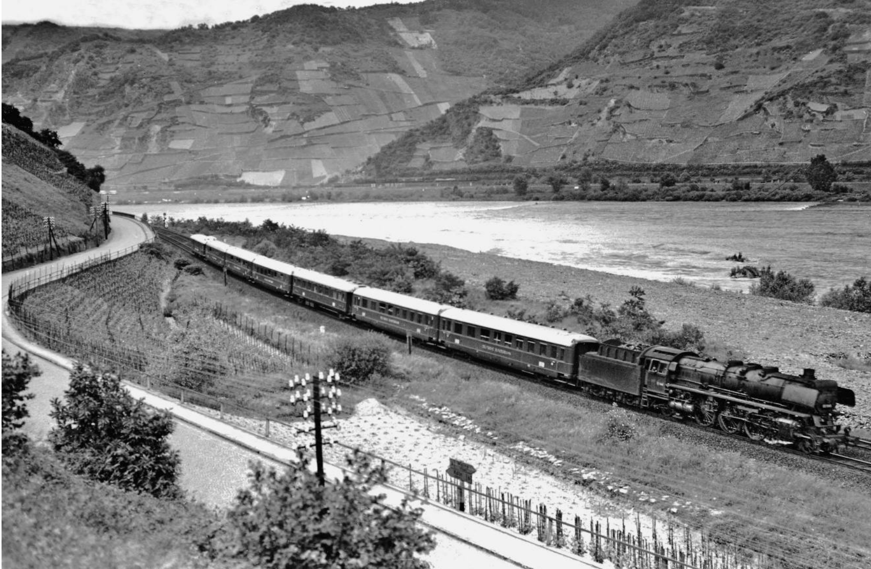
Vor allem in den Anfangsjahren setzt die Bundesbahn Schnellzug-Dampfloks für einige ihrer besten Züge ein. Am 3. Juni 1951 bespannt 03 1060 des Bw Ludwigshafen den wieder eingeführten „Rheingold-Express“ und eilt auf der linken Rheinstrecke zwischen Koblenz und Mainz bei Bacharach dahin. Die Lok besitzt einen Altbaukessel mit neuem Vorwärmer (dem „Knubbel“ vor dem Schornstein) Carl Bellingrodt/Arch. Eisenb.-Stiftg.
