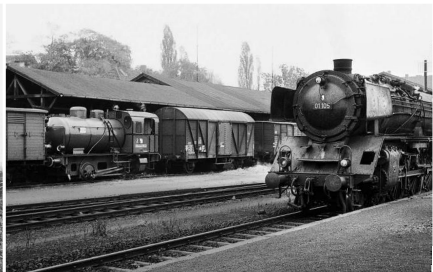
In Bad Salzuflen hält 1966 DB-Lok 01 105 neben einer Dampfspeicherlok der Hoffmanns-Stärke-Fabrik. Die Schutzmarke des Herstellers findet man auch auf der Werkslok: Eine Katze, die sich putzt. Weniger herausgeputzt wirkt da die DB-Maschine. Die Frontschürze hat Lücken, es sind unterschiedliche Signallampen aufgesteckt Dietrich Bothe
