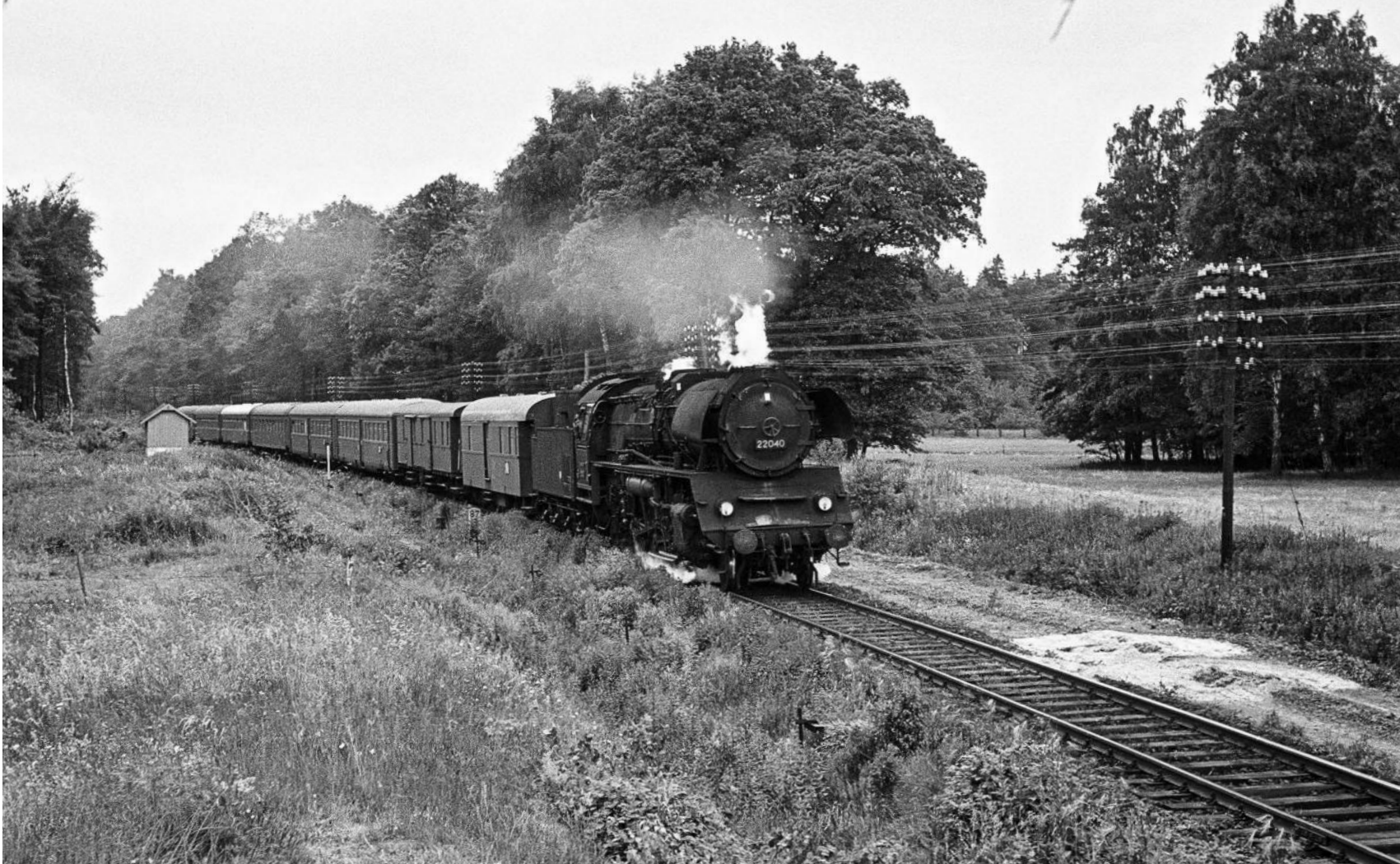
Die Baureihe 22, die rekonstruierte Personenzuglok 39 (pr. P 10), löste seit den späten 50er-Jahren sächsische Länderbahn-Schnellzugloks ab. Als im Juni 1968 dieses Bild mit 22 040 und ihrem Zug bei Radeberg entsteht, droht der Reko-Lok selbst schon das baldige Aus Alfred Luft
