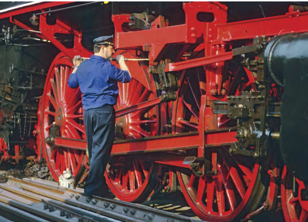
Ein Heizer der Reichsbahn ölt im Mai 1988 das Gestänge seiner (zweizylindrigen) 01.5 ab. Schon hier verlangt das Triebwerk viel Pflege. Bei Drei- und Vierzylinderloks müsste man zusätzlich noch die innen liegenden Triebwerksteile mit Öl versehen Dirk Höllerhage
