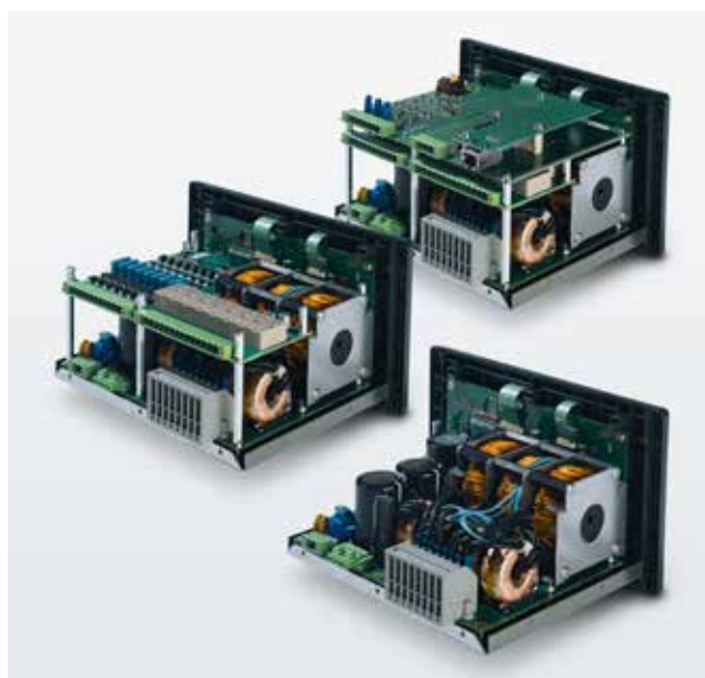
03 Внутренние компоненты устройства Powersave с функцией управления питанием, которая обеспечивает автономную работу и расцепление силового выключателя без использования ИБП
