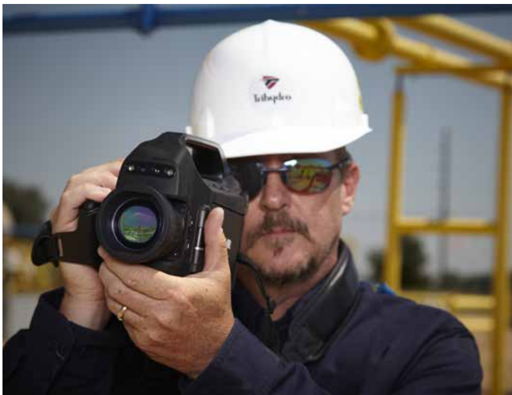
01 Камеры для оптической визуализации газа фирмы Flir предназначены для определения мест утечек на генераторах с водородным охлаждением
