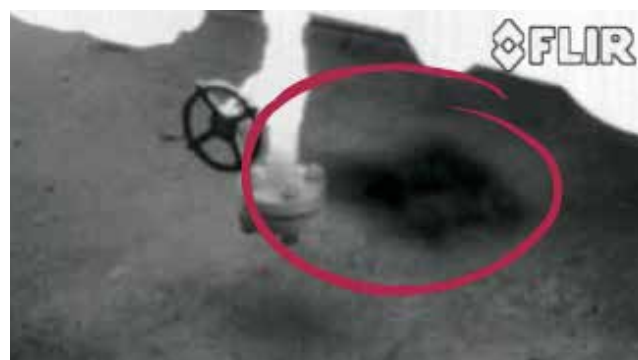
03 Камера Flir GF343 способна распознавать утечки углекислого газа ( \text{CO}_2 ) с концентрацией от 3 до 5 %
