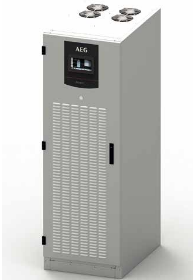
04 Protect Flex фирмы AEG PS – полностью модульный трансформаторный ИБП со встроенным резервированием n+x, 1–4 модулями, заменяемыми в «горячем» режиме, байпасным модулем и центральным разъемом для подключения батареи
