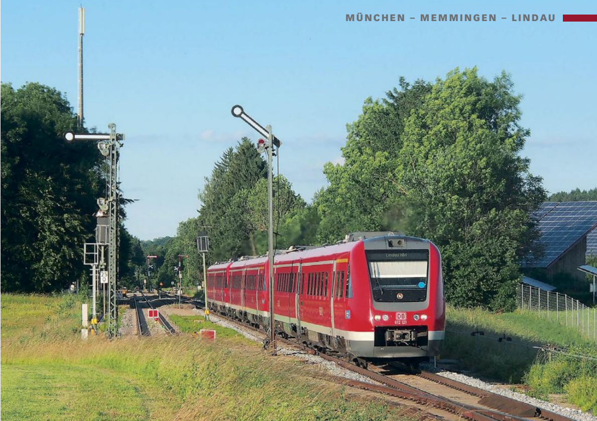
Als RE 57418 am 17. Juni 2017 die Betriebsstelle Stetten durchheilt, künden die aufgestellten Lichtsignale schon vom baldigen Ende der mechanischen Stellwerkstechnik
