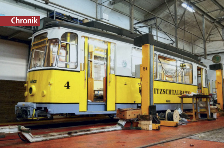
Bad Schandau: Der schon lange in Aufarbeitung befindliche, grundsanierte Tw 4 ist technisch wieder fahrbereit und sieht seiner Komplettierung entgegen, um 2021 wieder in Dienst zu kommen TORSTEN BAUCH
