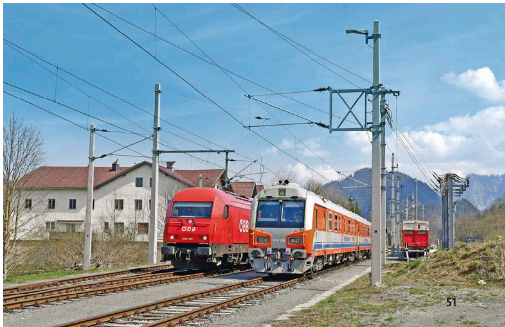
Bei den Österreichischen Bundesbahnen ist eine Mischung aus deutschen und schweizerischen Fahrleitungselementen typisch, wie hier im Bahnhof Vils zu sehen Markus Inderst
