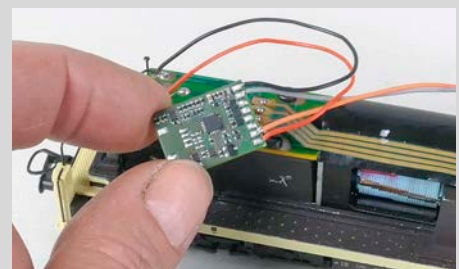
Streng genommen genügen vier Kabel zur Nachrüstung des digitalen Fahrbetriebs: die zweipolige Stromversorgung des Decoders und die Verbindung zum Motor. Licht- und Sonderfunktionen sind zwar möglich, aber vom Grundsatz her nicht zwingend notwendig
