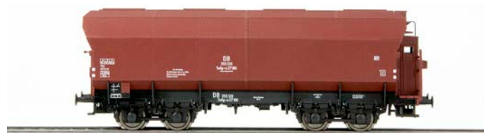
Der Tadg der DB ist eine Spezialkonstruktion aus den 1930er-Jahren. Er besitzt vier zum Teil verschiebbare Radsätze. Fleischmann setzte dem Exoten in HO ein Denkmal Michael U. Kratzsch-Leichsenring (5)
