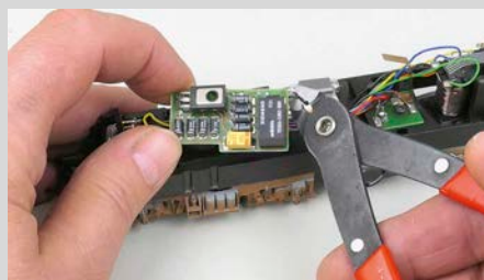
Vor dem Einbau des Digitaldecoders bzw. der Schnittstellenplatine muss die alte Steuer-elektronik ausgebaut werden – hier ein elektronischer Umschalter von Märklin zur Fahrtrichtungsumkehr
