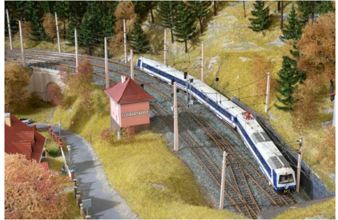
Typisch für Österreichs Trassen sind Betonmasten mit rechteckigen Querschnitten. Diese werden auch für Tragwerke benutzt. Wie in Deutschland sind es Trageilkonstruktionen statt Joche
