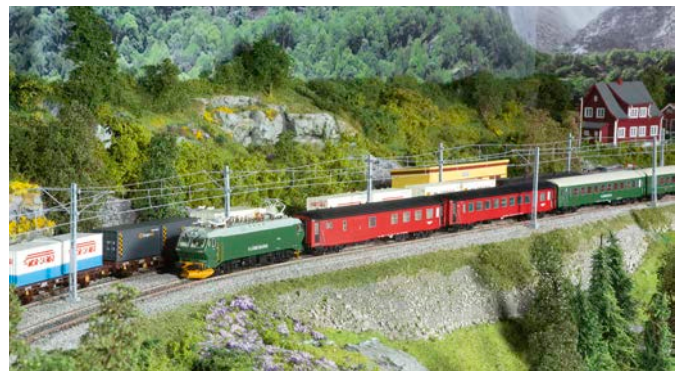
Die Fahrleitung dieser Flåmbahn-HO-Anlage besteht aus einer Kombination von Sommerfeldt-Reichsbahn-Masten samt ÖBB-Auslegern und Einheitsfahrdrathelementen Michael U. Kratzsch-Leichsenring (7)
