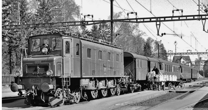
Die zwischen 1920 und 1929 in insgesamt 114 Exemplaren gebaute SBB-Reihe Ae 3/6' war für den Einsatz im Flachland konzipiert. Mit über sieben Jahrzehnten Einsatzzeit war sie eine der langlebigsten Lokserien der Schweiz. Am 12. März 1967 steht Ae 3/6 10611 mit einem Personenzug im Bahnhof Kreuzlingen und wartet auf das Verladen der Milchkannen Kurt Eckert/Slg. Eisenbahnstiftung
