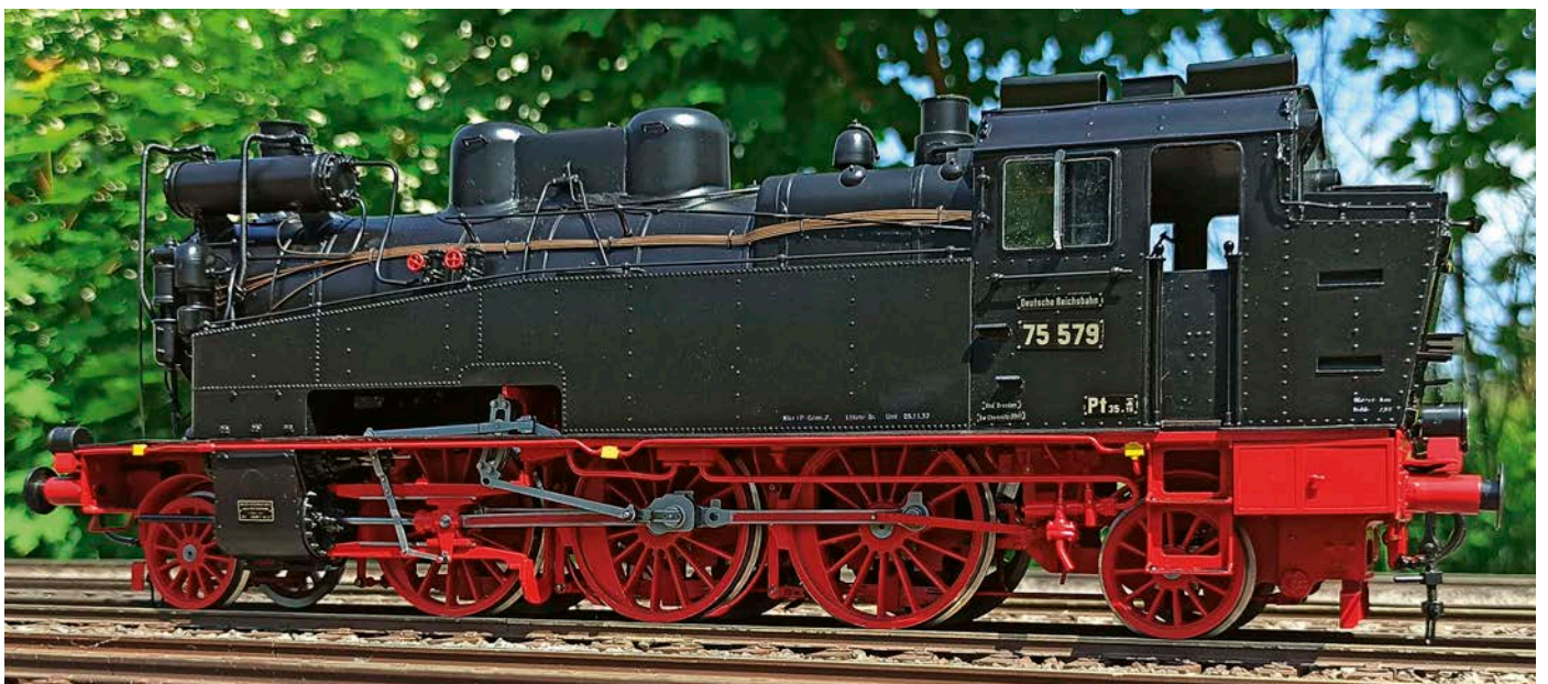
Durch die unterschiedlichen Kesselaufbauten ist die Baureihe 75 s leicht von den Schwestermaschinen zu unterscheiden Carl Bellingrodt/Slg. TechnikMedia
