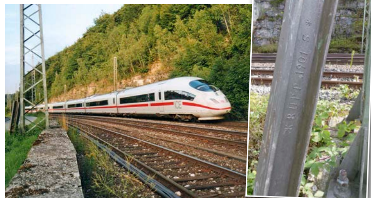
Im Jahre 2009 im Altmühltal fotografierter ICE mit dem links zu sehenden Fahrleitungsmast, der durch ein altes Krupp-Schienenstück geschützt wird, das inzwischen grau lackiert wurde Rainer Kamienski (2)
