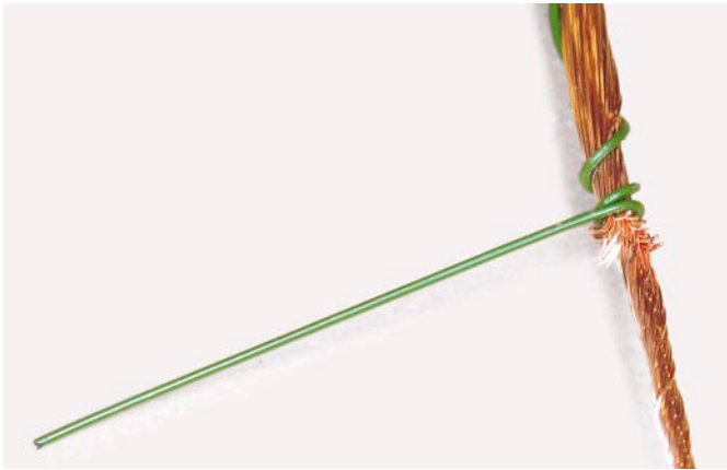
Die Kupferdrahtbündel werden mittels Blumenbinde- drahtumwicklung stabilisiert
