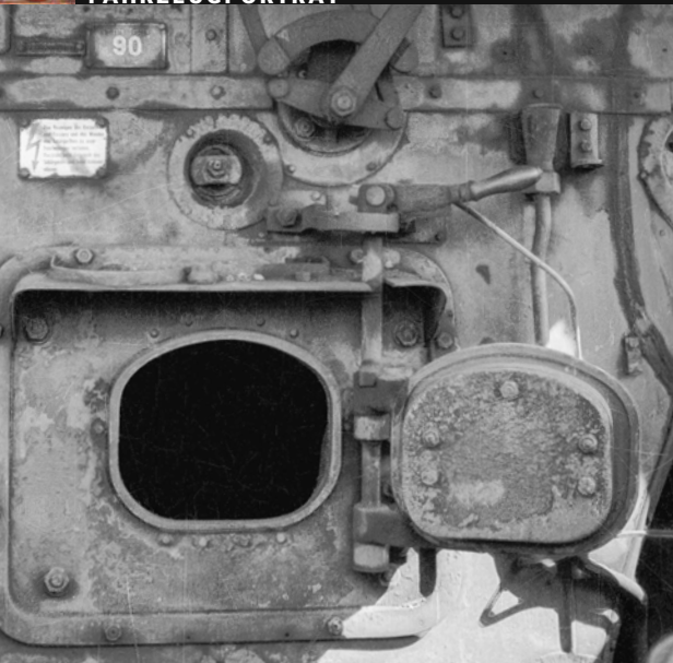
Zum Lokführer hin aufklappende Feuertür der 38 219, 1962 in Freiberg abgestellt P. Saby/Slg. M. Hengst
