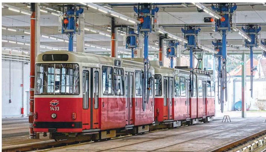
Ein E 2-c3 -Zug steht in der tagsüber ziemlich verwaisten Halle. Die hängenden Schläuche gehören zur Sandfüllanlage
