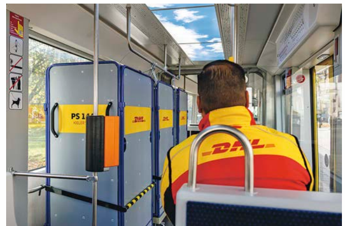
Mit speziellen Halterungen werden die Rollcontainer während der Fahrt in den Triebwagen gesichert
