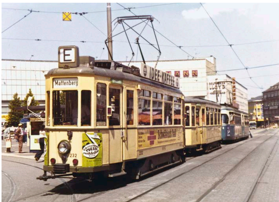
Zwei Fahrzeuggenerationen von Credé im Juni 1976 auf dem Königsplatz: Ein Zweiachser von 1941 steht vor einem Gelenkwagen von 1956
