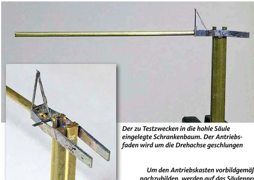
Der aus den Ätzteilen und einem 1 mm dicken Rohr zusammengebaute Schrankenbaum-Rohling
