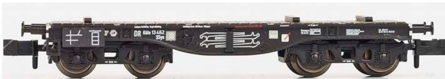
DRB SSys mit geschwungenem Fischbauchträger, Deutz-Drehgestellen und Ladeschwellen
