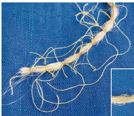
Ein 2 mm dicker Hanfstrang wird mehrfach in 8-9 mm Abständen mit Nähgarn abgebunden
