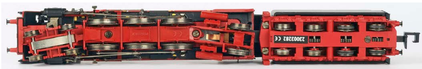
Minitrix: Angetrieben werden die drei hinteren Achsen des Tenders, wobei vier Haftreifen aufgezogen sind. Die Kabel zwischen Tender und Lok werden verdeckt innerhalb des schwarzen Kupplungssteiges geführt
