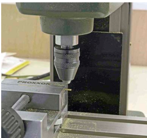
Für die exakt rechtwinkligen Arbeiten an der Schranke ist eine Ständerbohrmaschine/fräse erforderlich
