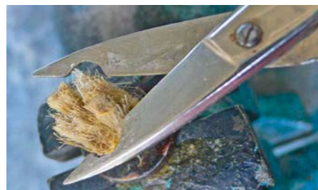
Alte Schere, in deren Klingen Einbuchtungen zum Fassen der Feime geschliffen sind
