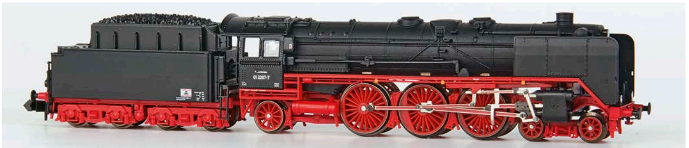
Arnold hatte ebenfalls Lokomotiven mit Wagnerblechen gefertigt, so auch die DR-Variante 01 2207-7 mit Scherenbremsen
