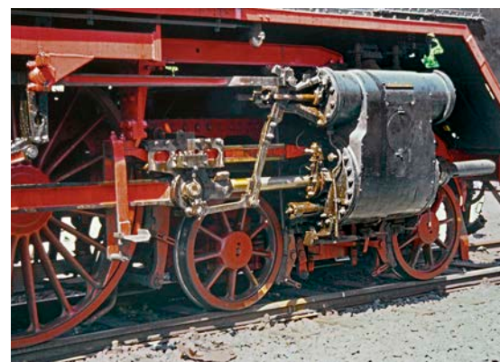
Kolben, Kreuzkopf und Gleitbahn der Heusingersteuerung bei der 01 118. Die Feinheit der großen Vorläufer-Speichenräder stellt an die Modellkonstruktionen bei der Nachbildung gewisse Herausforderungen
