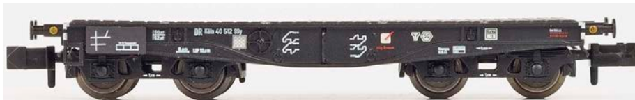
DRB SSy mit verstärktem Fischbauchträger und Deutz-Drehgestellen
