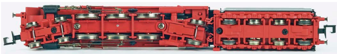
Fleischmann: Auch hier ist der Modellantrieb im Tender eingebaut. Der Motor wirkt auf dessen beide äußeren Achsen. Für eine optimale Zugkraft sind ebenfalls vier Haftreifen vorhanden. Auch der Nachläufer kann seitlich sehr weit auslenken
