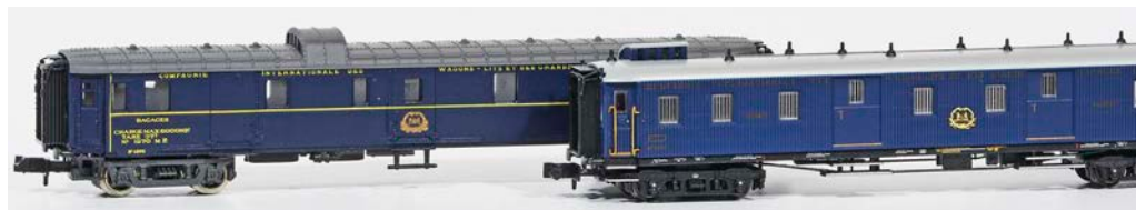
Vierachsige Packwagen der Standardbauarten der 1920/30er-Jahre aus Stahl (Rivarossi) und als umlackierter Teakholzwagen (Hobbytrain)
