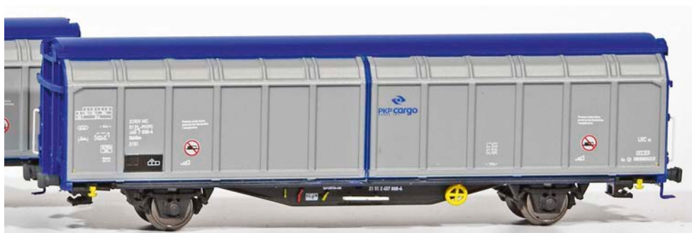
Blau/grau ist der Wagen von PKP Cargo. Die Stirnseiten sind mit einigen Steckteilen detailliert, wie auf dem rechten Bild zu sehen
