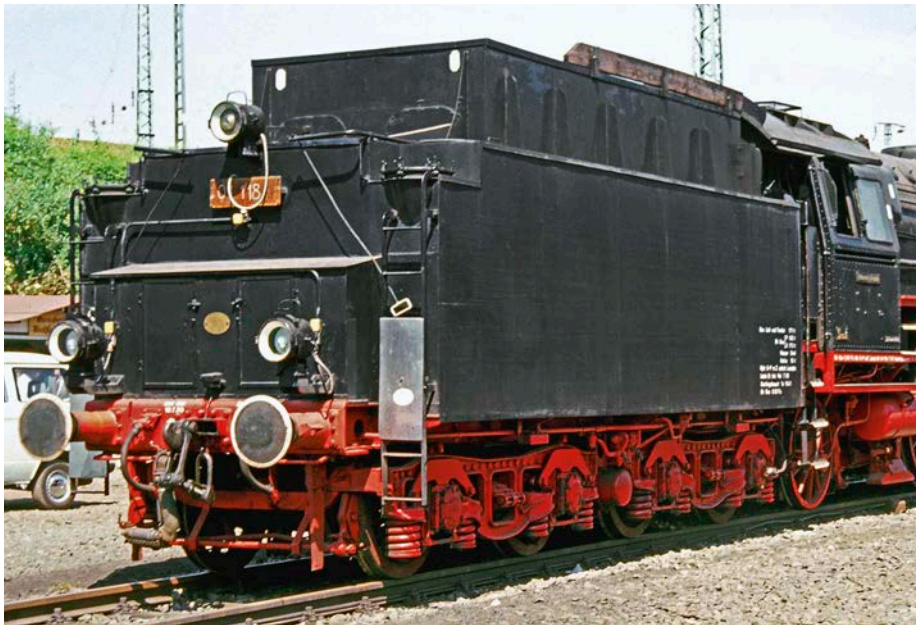
Der 2'2'T34-Tender der HEF 01 118 auf dem S-Bahn Fest in Köln 1990. Die Leitern sind mit Blechen gegen Heraufklettern gesperrt, und es gibt nur ein Behelfsnummernschild
