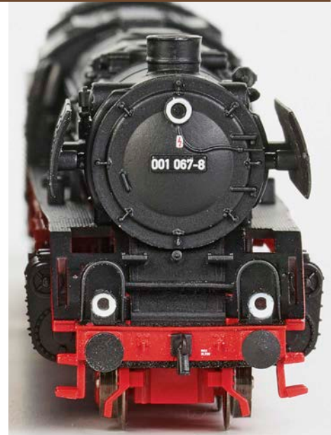
Die Zweizylinder-Baureihe 01 mit Witteblechen ohne Zurüstteile: DB 01 150 mit abgenommener Frontverkleidung von Minitrix, DB 01 102 noch mit Frontschürze von Fleischmann und DB 001 067-8 von Arnold wiederum mit der klassischen Schürze der Einheitslokomotiven
