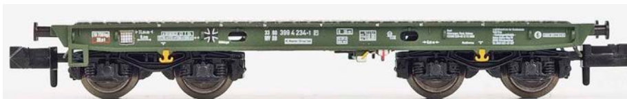
DB AG/BW Rlmp mit schmalen Rahmen mit Durchbrüchen und Y25-Drehgestellen
