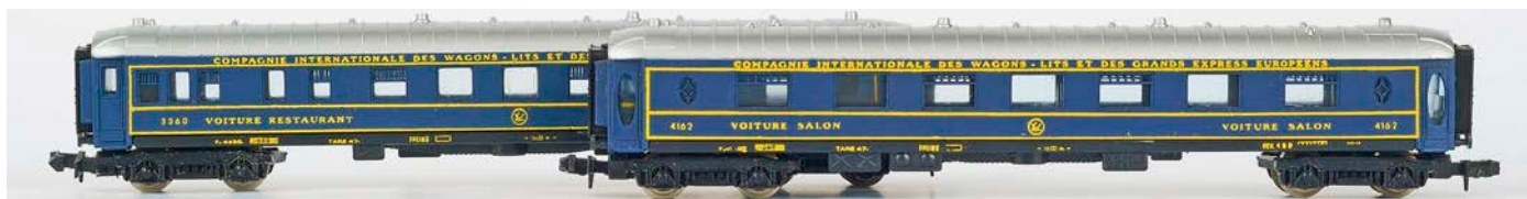
Lima lieferte gegen Ende der 1960er-Jahre verkürzte und vereinfachte Modelle eines WR 3360 und WP 4162 Typ Côte d'Azur mit dem grafischen CIWL-Emblem. Sie zeigen einige typische Details der Stahlwagen wie den mittigen Langträger, das Dach mit Nietenbändern, die ovalen Türfenster der Salonwagen und die kleinen, verstellbaren Lüftungsscheiben. Die Drehgestelle sind jüngerer FS-Bauart entlehnt
