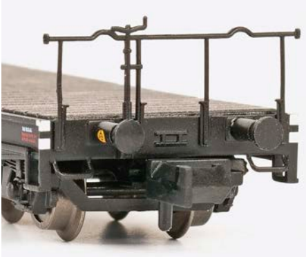
Das feine Geländer mit Bremskurbel kann an einer Stirnseite eingesteckt werden
