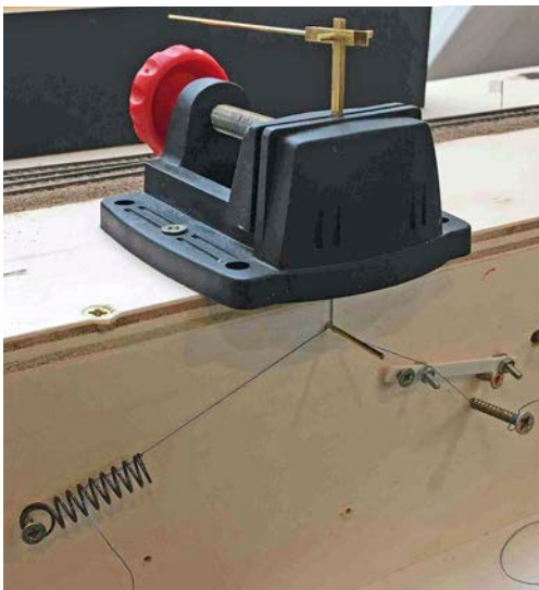
Der Testaufbau für die Schrankenbewegung: Die Schranke ist in einen Schraubstock geklemmt. Durch deren Ständer verläuft das Zugseilpaar nach unten über eine Umlenkachse zur Antriebsmechanik. Nach links geht es zur Zugfeder. Rechts wird der zweite Strang über den (hier noch händischen) Antriebswinkel zu einem starren Befestigungspunkt geführt. Beim Hochstellen des Winkels wird eine Zugbewegung am Faden bewirkt, wie auf dem rechten Bild zu sehen ist
