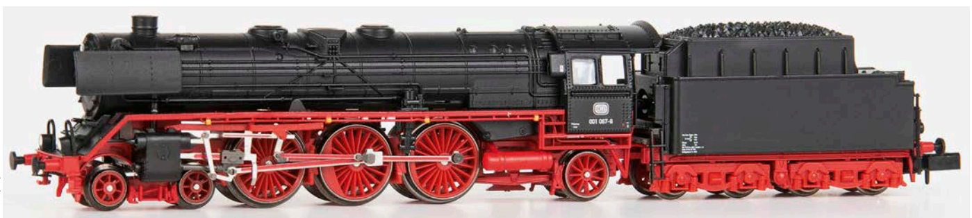
Arnold: DB 001 067-8 aus der frühen Epoche IV mit 850 mm Vorlaufrädern und einfachen Bremsen
