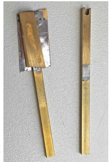
Um den Antriebskasten vorbildgemäßer nachzubilden, werden auf das Säulenprofil beidseitig Bleche gelötet und zugefeilt
