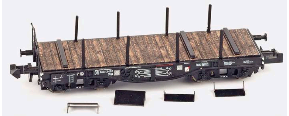
SSys mit montierten Rungen und Bühnengeländer samt Handbremskurbel. Davor liegen die aus Metall gefertigten Überfahrbleche der DRB-Modelle zur Ladeszenendarstellung
