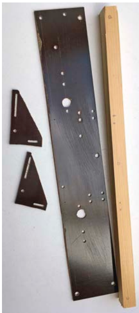
Antriebsträgerplatte für eine Doppelschrankenseite mit gebohrten Montagelöchern, dazu die beiden Stellwinkel für die Servos und Befestigungsleiste aus Holz
