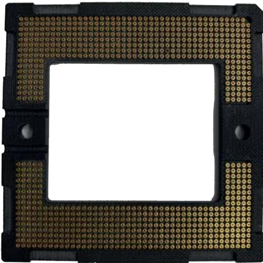
Jeder einzelne der 847 Kontakte eines solchen Sensorsockels muss korrekt ausgeführt sein. *Bild: EMC*
