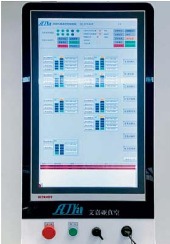
Ein Multitouch-Control-Panel CP2924 bietet auf 24 Zoll im Portraitformat einen klaren Überblick über aktuelle Systemdaten sowie Zoom- und Wischfunktionen für die komfortable Bedienung. *Bild: AJYa*
