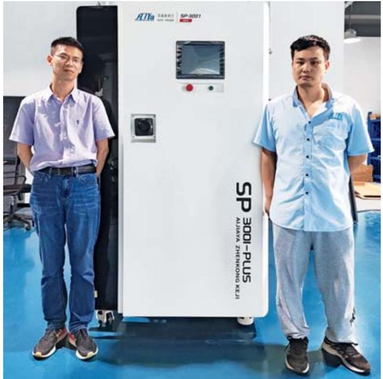
Die AJYa-Experten Jinping Sun und Wengang Dai neben einem Ultrahochvakuum-system der SP-Serie, in dem PC-based Control für die optimale Steuerung der mehrstufigen Vakuumerzeugung in Automotive-Druckgussmaschinen sorgt. *Bild: AJYa*
