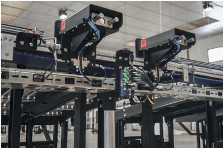
Über die ASI-5-E/A-Module BWU4231 von Bihl+Wiedemann werden optische Sensoren und pneumatische Aktuatoren eingebunden.
