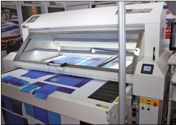
Der Laserschneider Contour Cut von Cadcam erfasst das aufliegende Textil automatisch und erstellt eine Vektordatei für das Schneiden.
