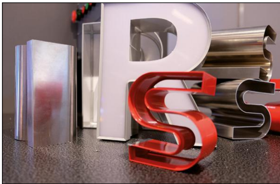
Der Supreme Letter Bender kann 16 Zentimeter hohe Buchstaben erstellen.
