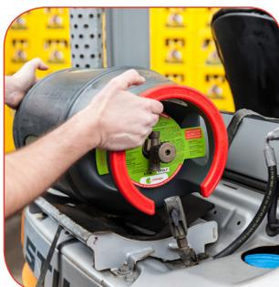
Placez la bouteille Calypso LT horizontalement sur le support du chariot. Assurez-vous que la sortie du robinet est dirigé vers le bas.
