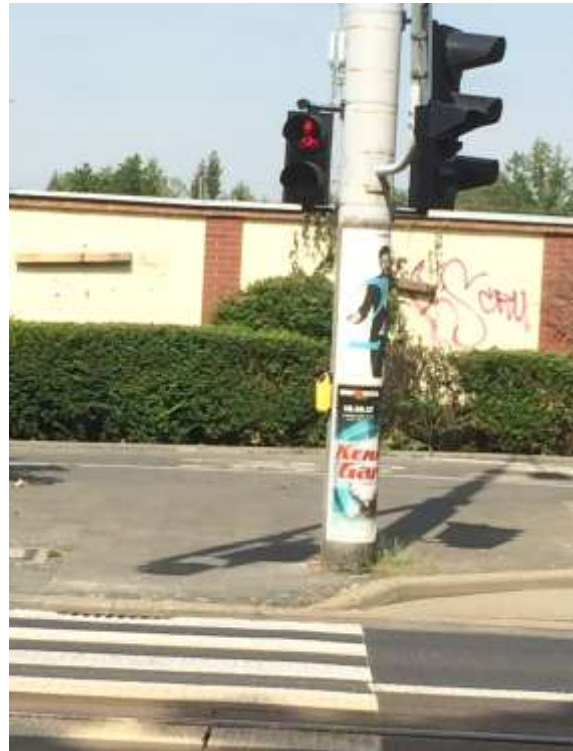
Gecombineerd verkeerslicht voor fietsers en voetgangers in Polen
