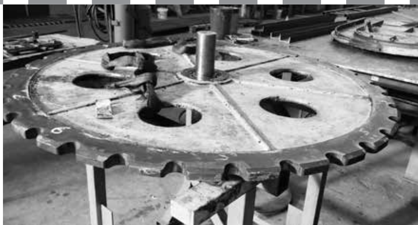
Het tandwiel van het retour gedeelte van één van de roltrappen. Beeldrecht gemeente Rotterdam
