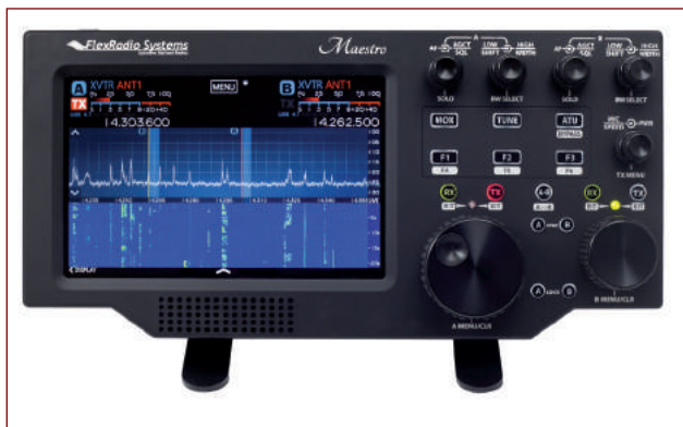
Figura 4. Panel frontal del Maestro idéntico al del Flex-6400M
