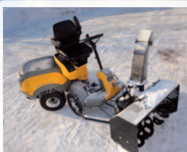
Midjestyrt: Smidighet og mulighet for stor presisjon på redskapet foran er to av midjestyringas fordeler.
