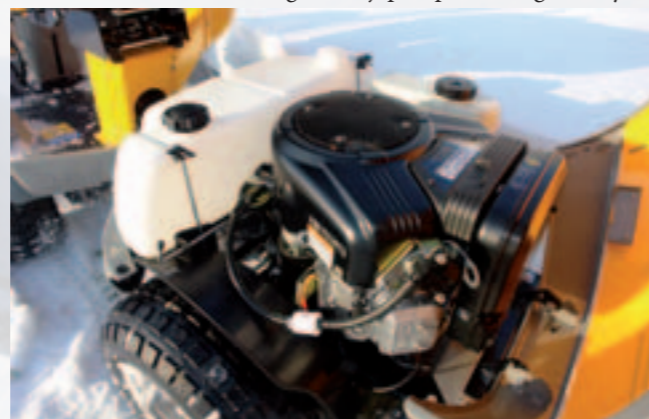
Stille: Den tosylindrede V-motoren på 20 hester fra Briggs & Stratton går pent og stille.
