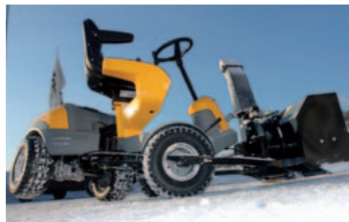
Tung: Snøfreseren er relativt tung for en så lett maskin. Ved full sving letter det ene bakhjulet, når det ikke har vekt. Legg merke til at redskapene har nedre oppheng på forselselen. Enkelt og solid.
