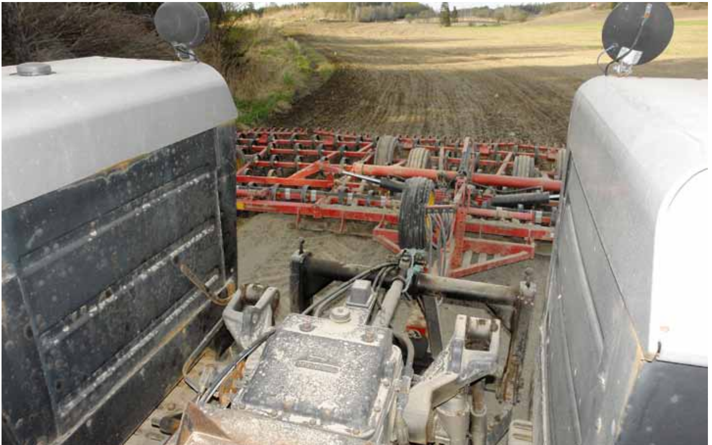
SIKT: Sikten er grei bakover til redskapen. Rolf Gjørstad bruker et amerikansk drag, der trekkbolten sitter i løftearmene via ei solid hurtigkoblingsramme. Traktoren har også vanlig landbruksdrag.
