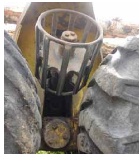
Enkel drift: Rullen som driver bakhjulene, presses ned mellom hjulene når det er ønskelig med drift på bakvogna. Men aksler og oppheng til denne drifta var en svakhet på de tidligste modellene. Dessuten kan du ikke sette på kjetting!
