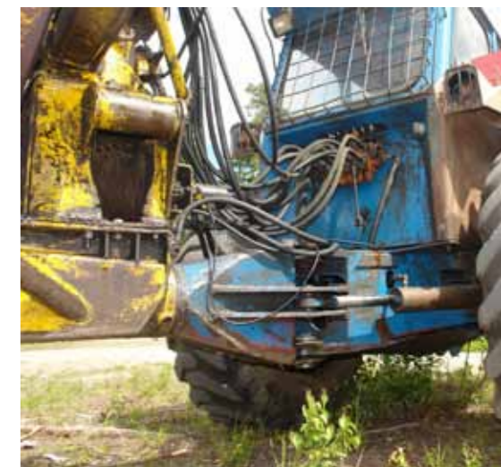
Ramme: Ei solid ramme måtte til for å kunne forbinde traktorkroppen med bakvogna. Til venstre ses åpningen til vinsjen under krana, men denne vinsjen har Anders og Anne Kari Taraldrud knapt brukt.
