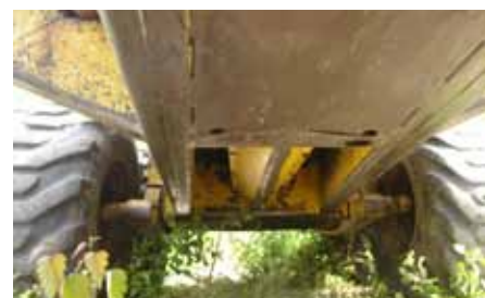
Ikke høyt: Bakkeklaringa er ikke stor til å være en skogsmaskin. Til gjengjeld er buken rein uten mye som kan hekte seg fast
