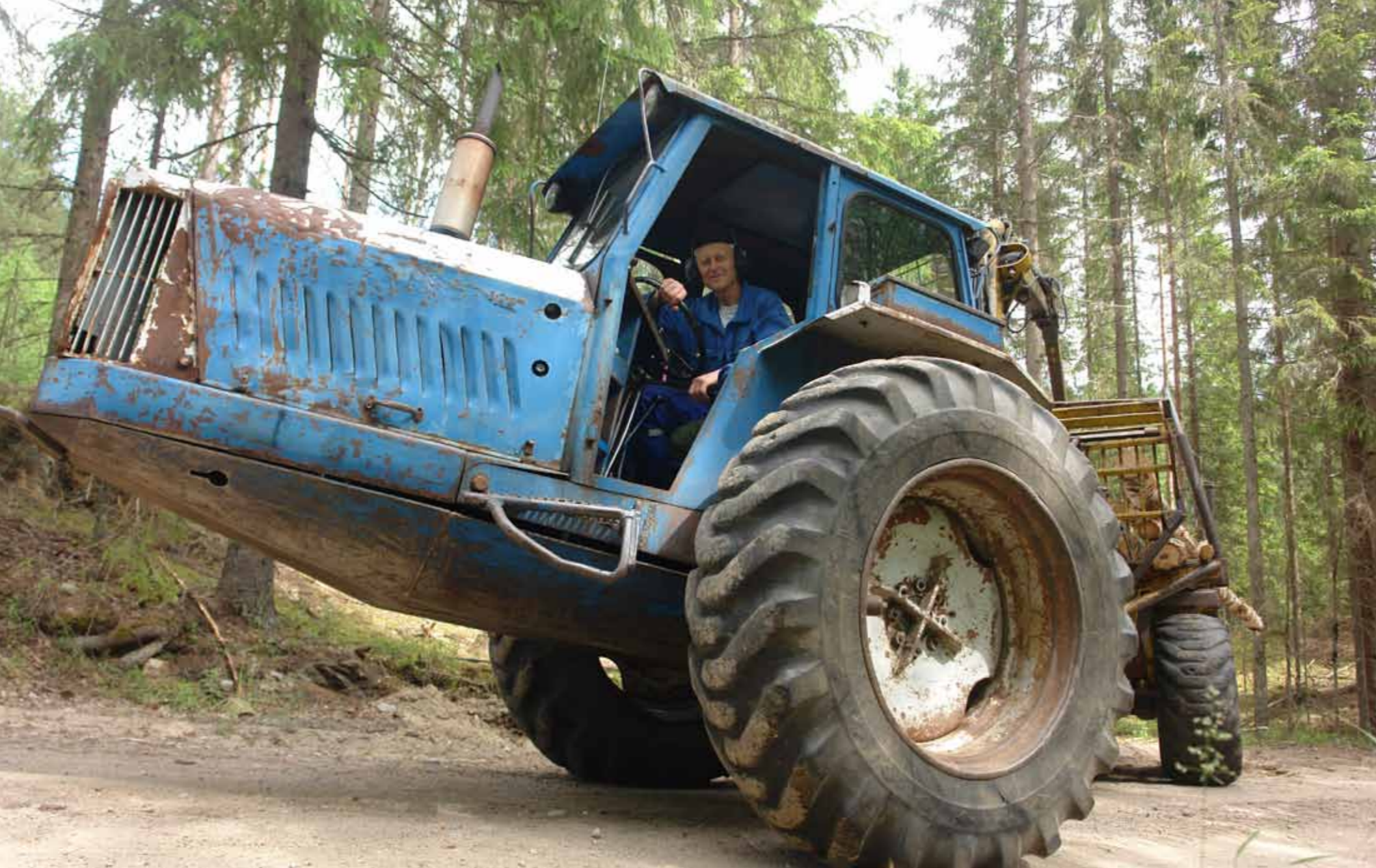
Høy i snuta: Å la snuta peke såpass i været kan synes unødig, helt til du ser hvor lett det er å stikke nesa ned i ting når det kjøres i skogen. Rottne har valgt kortere neser på seinere modeller. Men her er det brukt en «skid» fra Ford, med motor og bakaksel plassert som på en traktor.
