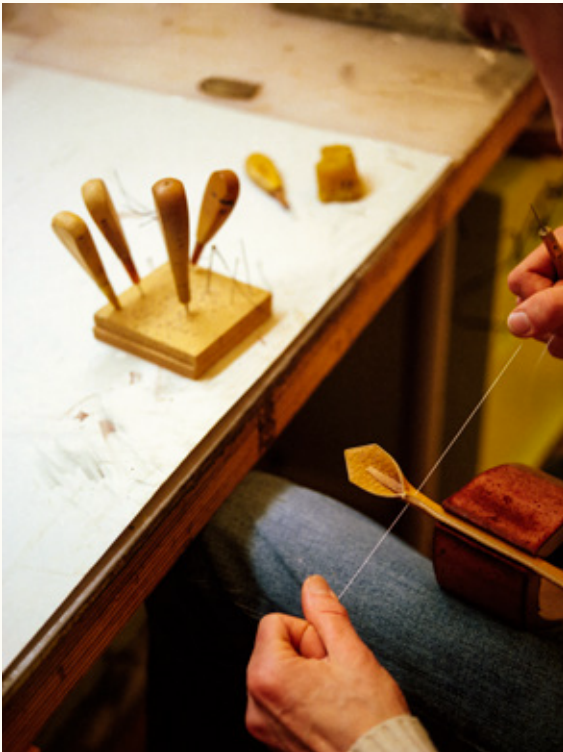
Sømmen som lærartiklene hos Hermès sys med, er hentet fra sadelmakerfaget. Det blir også brukt maskinsømmer der materialene krever mer styrke enn det menneskelig kraft og presisjon makter. Mye av verktøyet er individuelt, men stansene som brukes til å stiple læret, må håndverkene dele på. Foto: Jérôme Galland for Hermès
