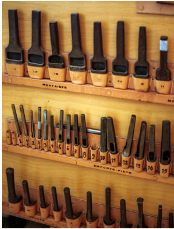
Sømmen som lærartiklene hos Hermès sys med, er hentet fra sadelmakerfaget. Det blir også brukt maskinsømmer der materialene krever mer styrke enn det menneskelig kraft og presisjon makter. Mye av verktøyet er individuelt, men stansene som brukes til å stiple læret, må håndverkene dele på. Foto: Jérôme Galland for Hermès
