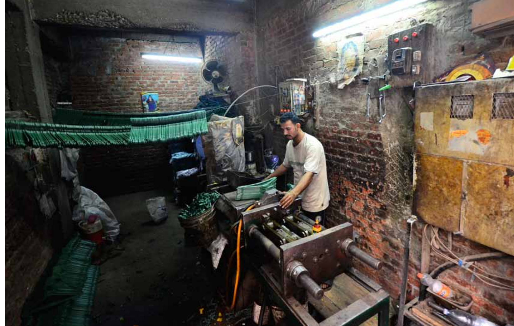
PRODUKSJON: Mohamet Sahlet lager kleshengere av varm, smeltet plast. Han og kollegaene produserer rundt 6000 i uken.
