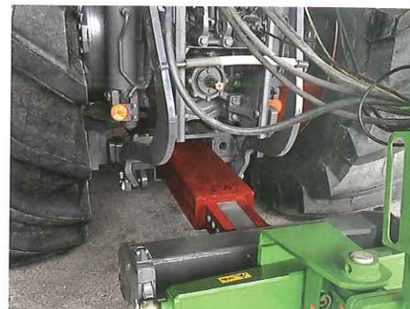
För att underlätta tillkoppling av redskap går den nya kopplingen att sänka. Illustration Fendt.
