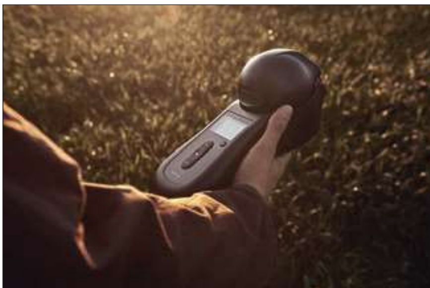
Det håndholdte GrainSense-apparat måler indholdet af protein, fugt, olie og kulhydrat i korn og andre afgrøder - nøglemålinger, der afgør høstens værdi og forarbejdningsomkostningerne. (Foto: PR).
