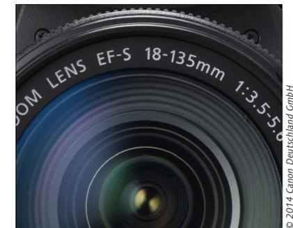
Abb. 3.51 | Tatsächlicher Brennweitenbereich dieses Objektivs an einer Canon EOS 700D mit APS-C-Sensor: 18 mm – 135 mm. Auf Kleinbild übertragen entsprechen die Sichtwinkel 28,8 mm – 216 mm.
