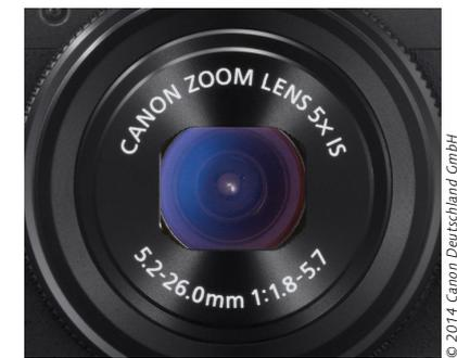
Abb. 3.50 | Der tatsächliche Brennweitenbereich dieses Objektivs beträgt 5,2 mm – 26 mm. Daraus ergeben sich Sichtwinkel, die 24 mm – 120 mm im Kleinbild entsprechen.
