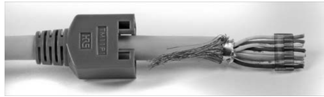
Abbildung 2.19 Zusammengedrehte Abschirmung, Adern durch Kammpalte gesteckt
