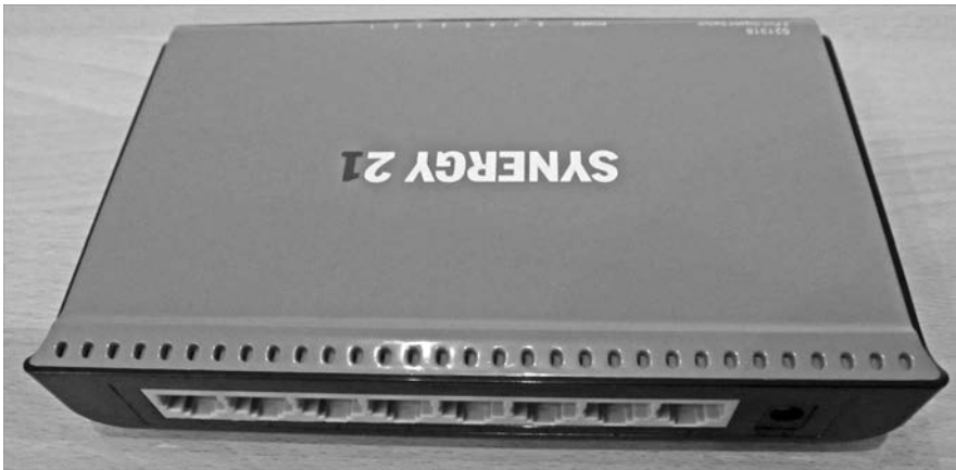
Abbildung 10.35 Tisch-Switch »S21318« der Firma Synergie 21, ohne Management-Modul
