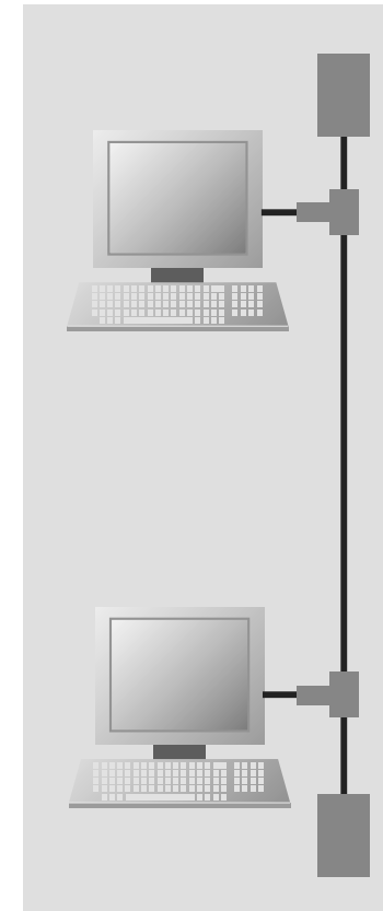
Abbildung 2.1 Bus-Struktur von Netzwerken mit Koaxialkabeln
