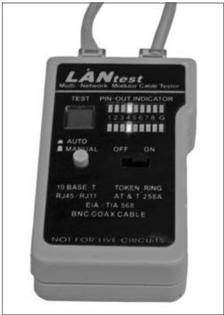
Abbildung 2.26 Prüfung der Patchkabel
