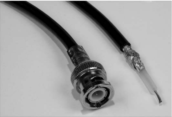
Abbildung 2.2 BNC-Stecker und Koaxialkabel Cheapernet (10Base-2)
