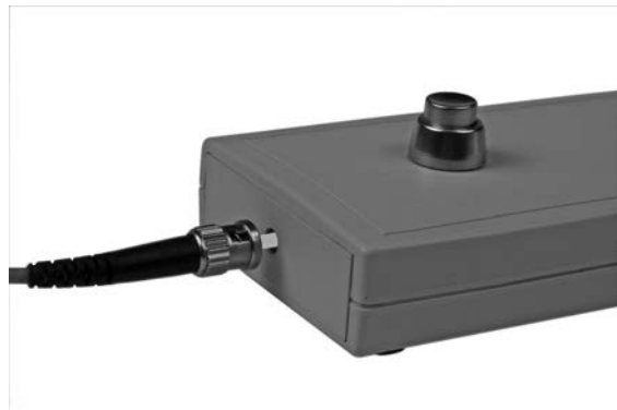
Abbildung 2.41 Eigenbau-LWL-Tester mit Adapterkabel ST
