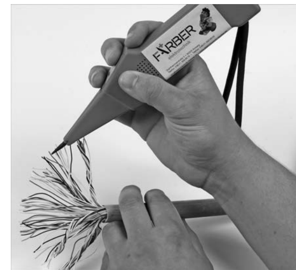
Abbildung 2.30 Arbeiten mit dem Tastkopf an einem Adernbündel
