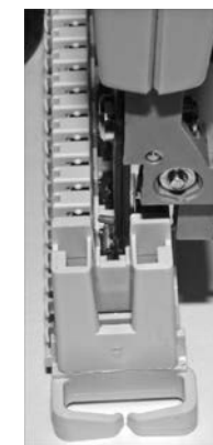
Abbildung 2.14 Die richtige Position des Anlegewerkzeugs
