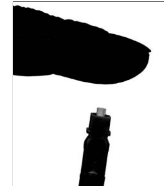
Abbildung 2.40 Hier droht Gefahr für LWL-Komponenten!
