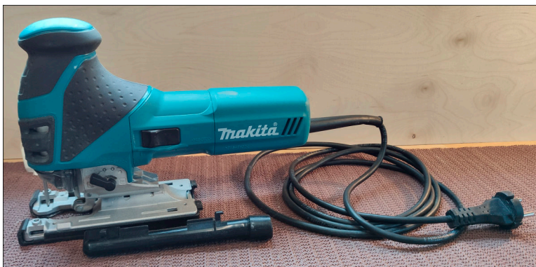
Abbildung 5.30 Eine Stichsäge mit Knaufgriff
