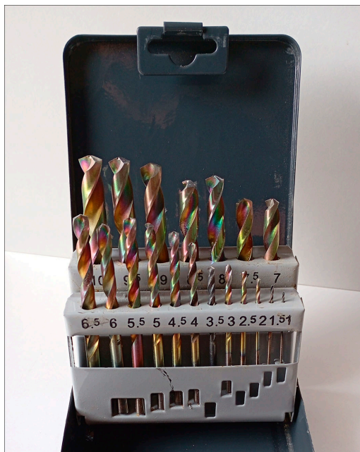
Abbildung 5.28 Ein Sortimentskasten mit Metallbohrern in den gängigen Größen
