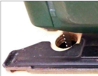
Abbildung 5.31 Der Start eines Ausschnitts von einem Loch aus
