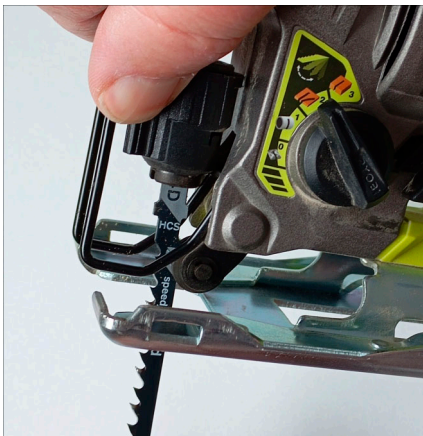
Abbildung 5.33 Die werkzeugfreie Schnellverriegelung der Sägeblattaufnahme und die Einstellung des Pendelhubs
