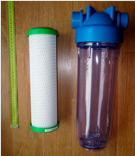
Abbildung 10.4 Einbau-Wasserfilter mit Aktivkohlefilter
