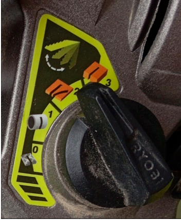
Abbildung 5.34 Die Pendelhubeinstellung einer modernen Stichsäge – die Abbildung der Materialien macht die Auswahl einfach.
