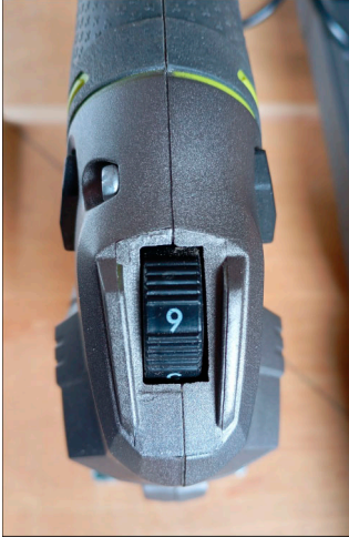
Abbildung 5.35 Die Geschwindigkeitseinstellung einer Stichsäge wird über ein Drehrädchen am Griff justiert.
