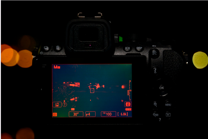
Abbildung 3.61 Mit dem Modus 1 der Individualfunktion d12 Warme Anzeigefarben wird das Monitorbild rot eingefärbt.
