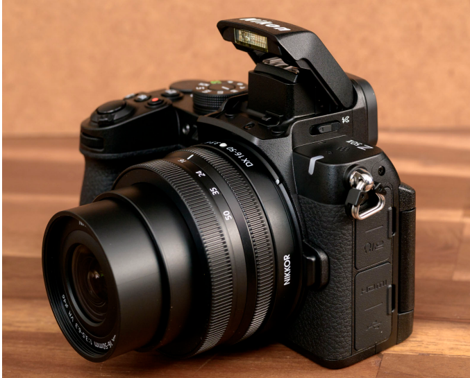
Abbildung 5.1 Der interne Blitz wird ausschließlich manuell per Schalter aufgeklappt.
