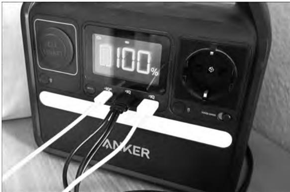
**Abbildung 9.13** Dieser von Solarzellen (außen am Fenster, daher nicht im Bild) versorgte Akku ist aktuell vollständig geladen. Neben diversen USB-Ladekabeln lässt sich ein handelsübliches Elektrogerät einstöpseln und per Wechselrichter mit 230 V versorgen.
