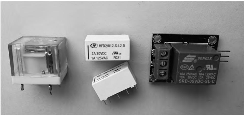
**Abbildung 4.11** Diese Relais in verschiedenen Bauformen sind für unterschiedliche Schaltleistungen geeignet. Das 250-Volt-Exemplar rechts besitzt praktische Anschlüsse für Verbraucher und Schalteingänge und wird gern von Mikrocontrollern angesteuert.
