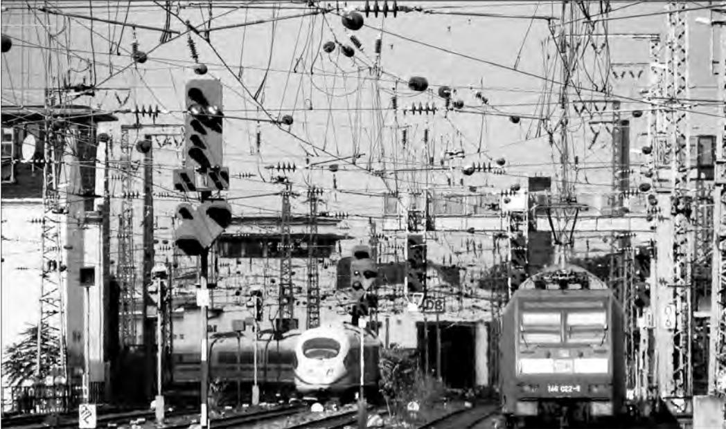
**Abbildung 9.4** Oberleitungen in der Einfahrt zum Kölner Hbf.: ganz schön komplizierter Drahtverhau. Sie können übrigens in dieser Aufnahme in der Mitte gut erkennen, dass der Fahrdrabt im Zickzack verlegt ist, um die Schleifstücke der Stromabnehmer gleichmäßig abzunutzen.
