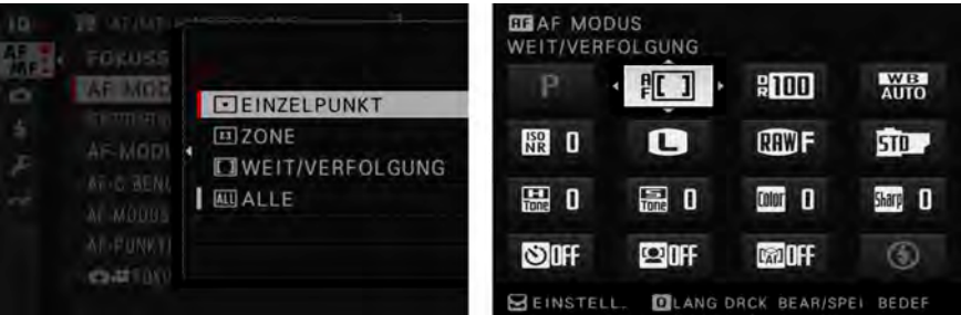
Abbildung 4.4 Links: Hier wählen Sie den AF-Modus. Rechts: Auch im Schnellmenü der Kamera finden Sie die Auswahl des Autofokusbereichs wieder.
