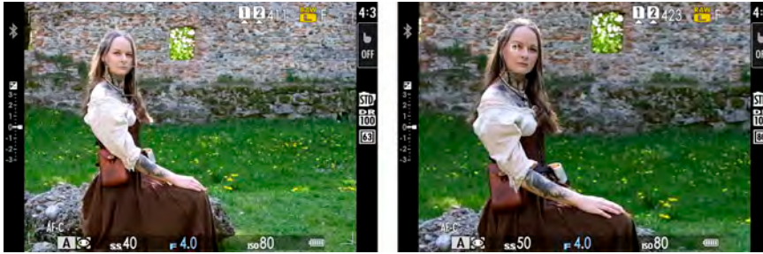
Abbildung 1.12 Hier wurde zum Vergleich noch tiefer in das Bild »hineingezoomt«. In der linken Abbildung ist das Motiv mit dem Crop-Zoom auf 63 mm (KB 50 mm) vergrößert, rechts habe ich die maximalen 80 mm (KB 63 mm) des Crop-Zooms verwendet. Ob und welche Zoomstufe Sie verwenden, wird rechts auf dem Display/im Sucher angezeigt (im Bild mit 63 bzw. 80).
