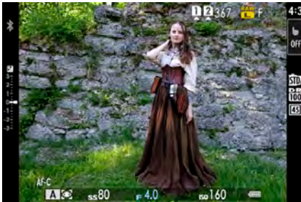
Abbildung 2.15 Das A links unten und der blaue Blendenwert zeigen an, dass Sie die Blendenvorwahl eingestellt haben. (Model: Annika Fendt)
