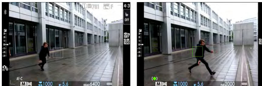
Abbildung 4.11 Links: Ich habe den Fokusrahmen als »Fokusfalle« etwas leicht links platziert und warte darauf, dass der Parkourläufer beginnt. Rechts: Der Parkourist kam in die »Fokusfalle«, wurde dank halb heruntergedrückten Auslösers auch gleich anvisiert und ...
