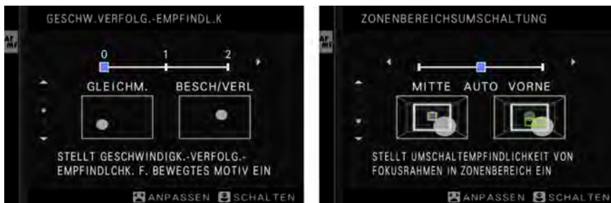
Abbildung 4.16 Links: Geschwindigkeitsverfolgungs-Empfindlichkeit ( Geschw.Verfolg.-Empfindl.K ) von 0 bis 2. Rechts: Einstellungen für die Zonenbereichsumschaltung
