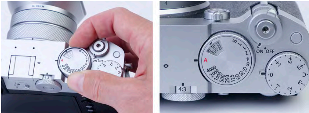
Abbildung 1.8 Links: Heben Sie das Einstellrad für die Belichtungszeit an, um den ISO-Wert anzupassen. Rechts: Dieser kleine ausgesparte Bereich am Einstellrad für die Belichtungszeit und den ISO-Wert zeigt den gewählten ISO-Wert an (hier ISO 800).
