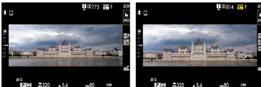
Abbildung 1.15 Links: Hier wurde das Seitenverhältnis-Wahlrad auf 65 : 24 gestellt, was auch in der Bildansicht so angezeigt wird. Das Seitenverhältnis wird rechts oben eingeblendet. Rechts: Zum Seitenverhältnis kann zudem über den Crop-Zoom-Hebel tiefer in das Bild »gezoomt« werden (hier 45 mm).
