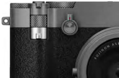
Abbildung 1.10 Mit dem Crop-Zoom-Hebel können Sie den Bildausschnitt durch Croppen anpassen.
