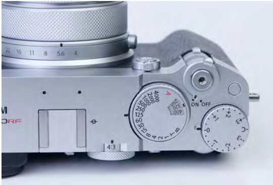
Abbildung 2.18 Ist keine Einstellung der Kamera mehr im Automatikmodus, liegt es an Ihnen, die Belichtung einzustellen.
