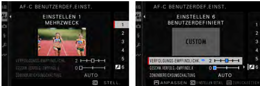
Abbildung 4.14 Links: Sie können zwischen fünf vordefinierten Sets für den kontinuierlichen Autofokus (AF-C) wählen. Rechts: Auch benutzerdefinierte Vorgaben lassen sich mit den drei vorhandenen Parametern erstellen.
