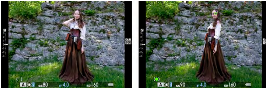
Abbildung 2.17 Links: Blende einstellen (hier F4.0 ). Rechts: Wenn Sie den Auslöser halb herunterdrücken, sollten Sie die Belichtungszeit (und eventuell auch den ISO-Wert) überprüfen. (Model: Annika Fendt)
