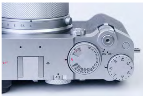
Abbildung 2.13 Für die Blendenvorwahl stellen Sie die Belichtung auf A .
