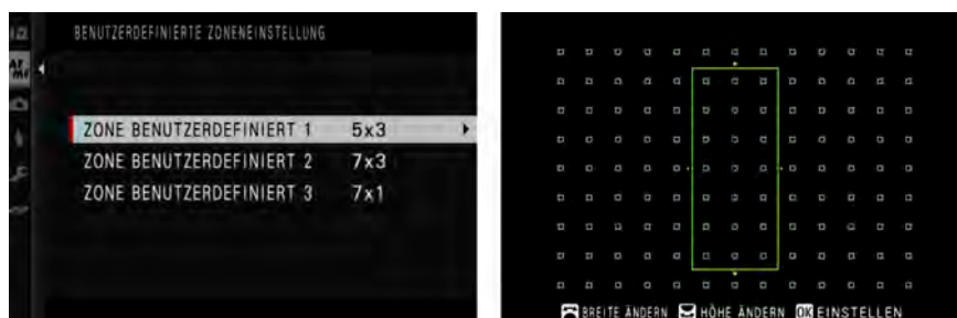
Abbildung 4.10 Links: Es stehen Ihnen drei benutzerdefinierte Zonen zur Verfügung. Rechts: Hier wurde die Zone 7 \times 3 zur Anpassung ausgewählt. Sie können die Zone nun beliebig in der Höhe und Breite ändern.
