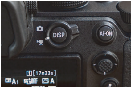
Abbildung 6.2 Für die Videoaufnahme stellen Sie den Wahlschalter auf das Filmkamarasymbol.
