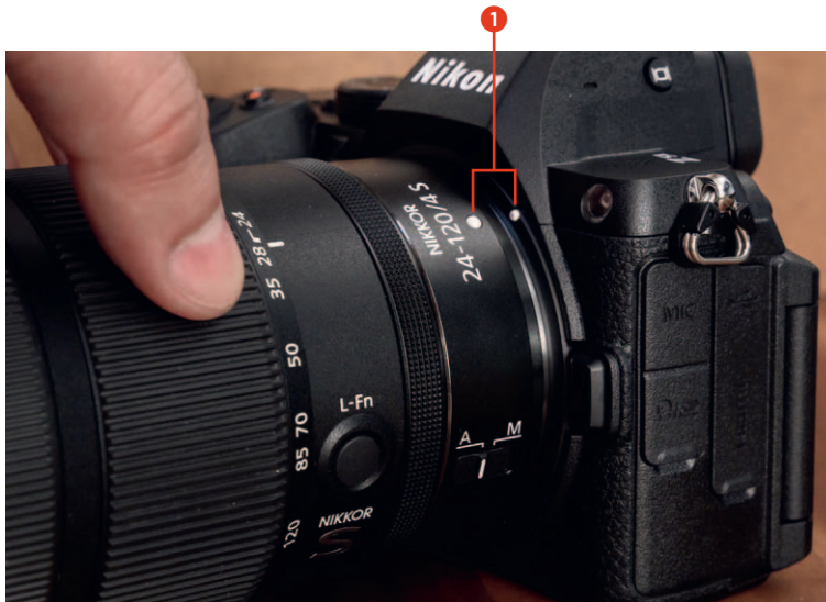
Abbildung 1.11 Richten Sie das Objektiv beim Ansetzen an den weißen Markierungen ❶ am Objektiv und an der Kamera aus.
