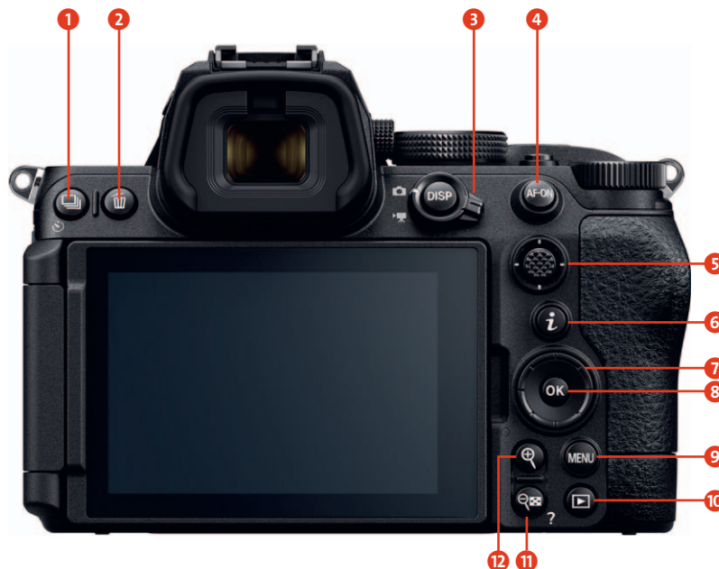
Abbildung 1.15 Der Joystick und der Multifunktionswähler dienen neben der Menünavigation und der Bildauswahl bei der Wiedergabe auch zur Auswahl des Autofokussmessfeldes.
