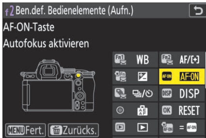
Abbildung 2.14 Die AF-ON-Taste ist standardmäßig mit der Funktion Autofokus aktivieren belegt.
