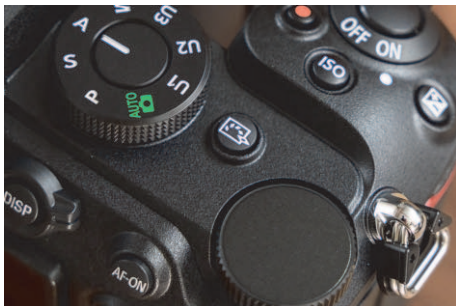
Abbildung 1.14 Die Picture-Control-Taste dient zur Auswahl des gewünschten Bildstils.
