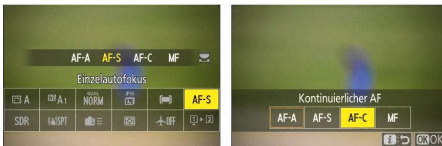
Abbildung 2.6 Die Einstellung des AF-Modus im i-Menü mit dem Einstellrad (links) und per Touch (rechts)
