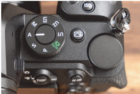
Abbildung 1.12 Mit dem Funktionswählrad rechts vom Sucher wählen Sie die Methode der Belichtungssteuerung.
