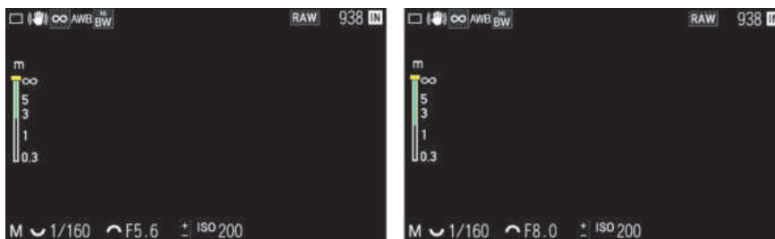
Abbildung 4.23 Links: Im Fokusmodus Unendlich bleibt der gelbe Balken immer am Unendlichkeitsymbol, um sicherzustellen, dass Motive in der Ferne scharf gestellt sind. Rechts: Trotzdem können Sie die Schärfentiefe über die Blende anpassen. Im Gegensatz zur linken Abbildung wurde die Schärfentiefe hier deutlich erweitert, indem die Blende weiter geschlossen wurde.
