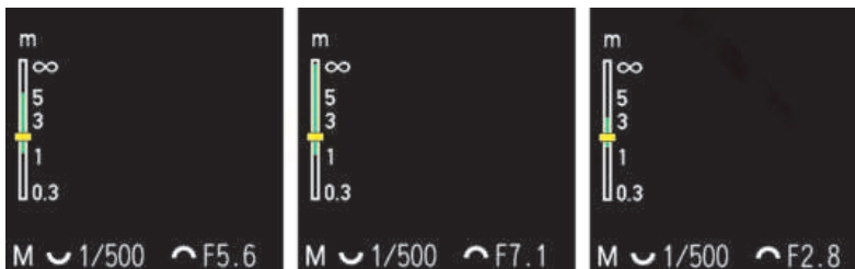
Abbildung 4.14 Wenn Sie die Entfernungsanzeige und Schärfentiefeskala verstehen, ist das manuelle Fokussieren mit der Ricoh GR IV ein Kinderspiel.
