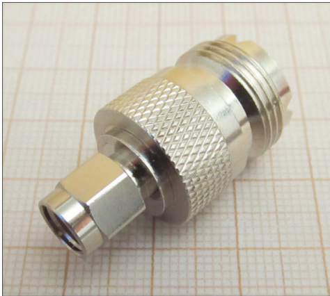
Abbildung 1.13 Adapter SO-259 auf SMA: die Seite des SMA-Steckers
