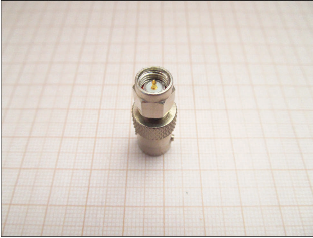
Abbildung 19.7 SMA-Steckerseite eines Adapters
