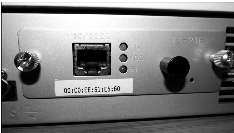
Abbildung 4.1: Aufkleber mit MAC-Adresse an einem internen Printserver
