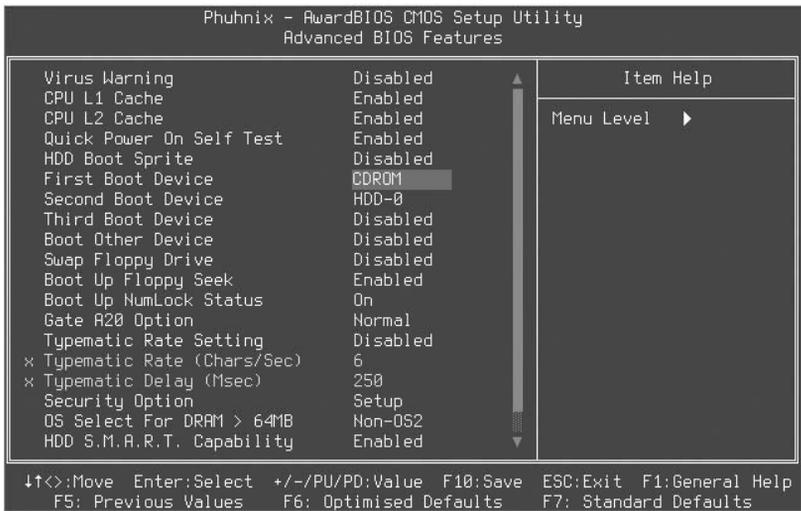
Abbildung 3.1 Stellen Sie die Bootreihenfolge für CD-/DVD-Laufwerke ein.
