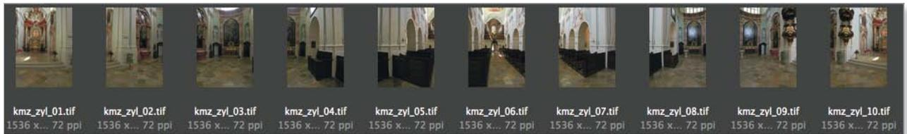
Für zylindrische Panoramen müssen die Einzelbilder kreisförmig angeordnet werden. Damit dabei die Überlappungsbereiche wirklich exakt übereinanderpassen, ist eine Verzerrung notwendig, wie die farblich markierten Bilder in Abbildung 3.4 zeigen. Das rot markierte Bild, das an beiden Bildrändern erscheint, schließt das Panorama präzise passend an der Nahtstelle 1.
